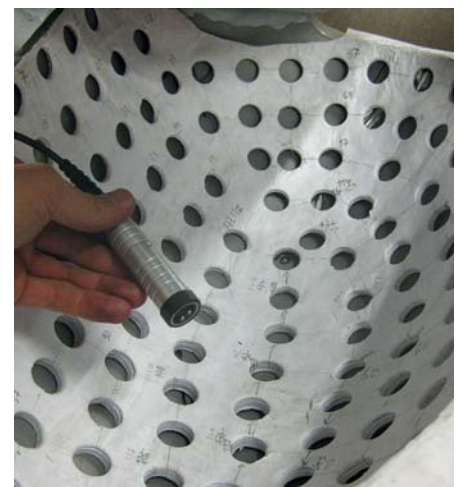
Bild 6. Anwendung einer Schablone für die Messung der Schichtdicken in einem Peltonbecher in der Zentrale des KW Fieschertal (Foto: VAW).
