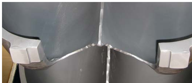
Bild 2. Hydro-abrasiver Verschleiss an Laufrädern im KW Fieschertal nach einer schwebstoffreichen Saison. Die Beschichtung wird meist zuerst auf der Mittelschneide und im Ausschnitt abgetragen (Foto: VAW).
