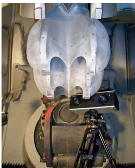
Bild 7. 3D-Digitalisierung im Turbinengehäuse des KW Fieschertal. Das optische Messgerät ist auf einem fahrbaren Stativ aufgebaut (Foto: HSLU).
