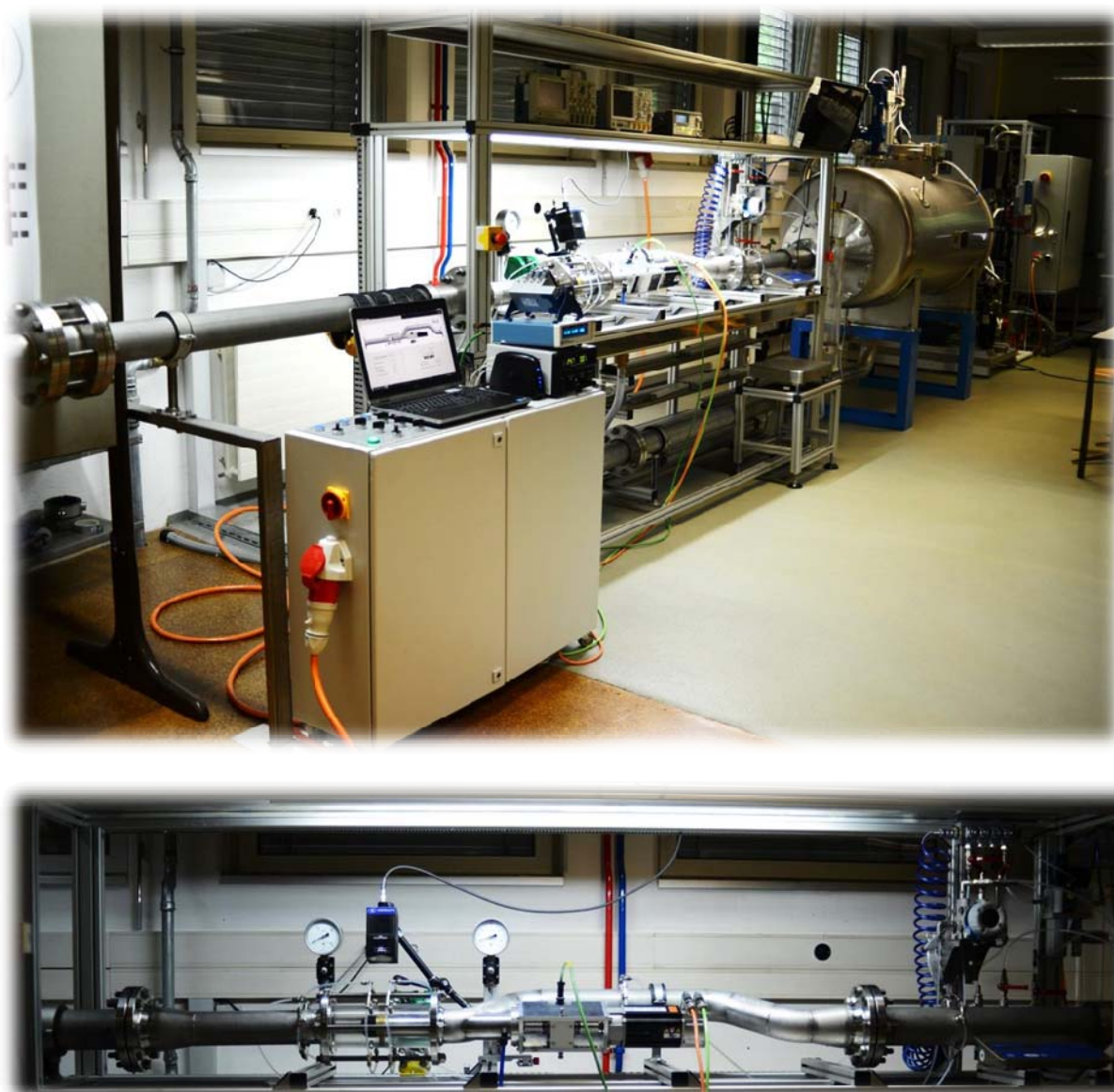
Figure 12 – Modèle réduit de la pico-turbine installé sur le banc d'essais.
