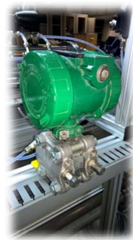
Figure 15 – Setup pour la calibration des capteurs de pression différentielle et absolue.
