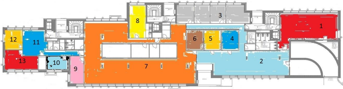
Abbildung 7: Grundriss mit den Zonen der Lüftung
