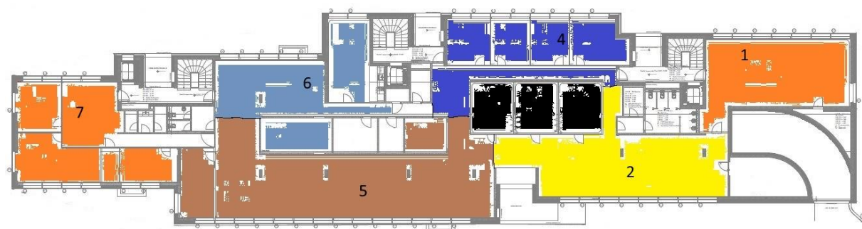
Abbildung 6: Grundriss mit den Zonen der Fussbodenheizung
