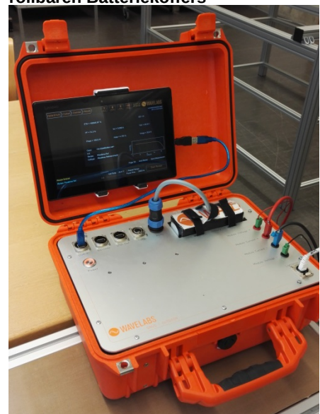
Abbildung 8: Koffer mit der Messelektronik und dem Tablet als Human Machine Interface
