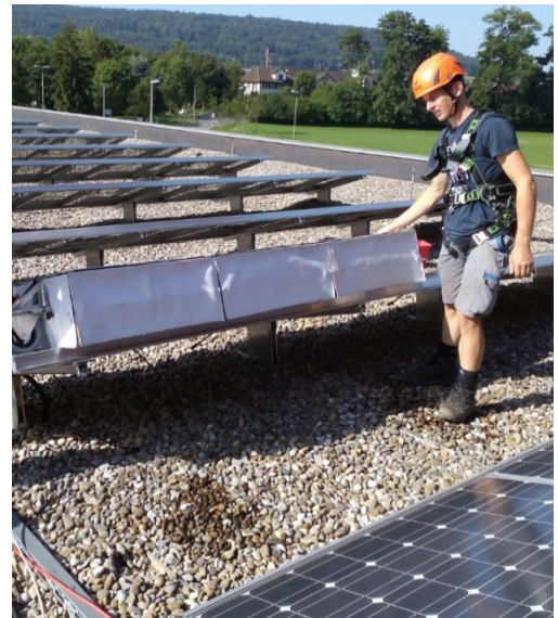
Abbildung 9: Der Portable LED Flasher im Einsatz auf der Anlage „Die Werke“ in Wallisellen
