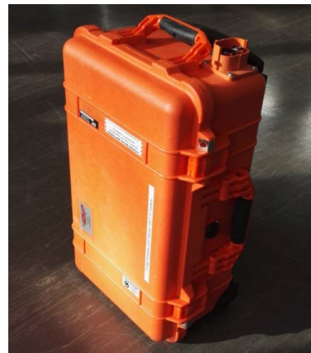
Abbildung 7: Seitenansicht des rollbaren Batteriekoffers
