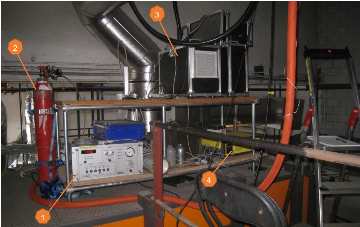
Abbildung 16: Messgerätschaft der FHNW an Messstelle 2 auf dem Kessel mit FID (1) inkl. H 2 -Flasche (2), MRU (3) und FTIR (4)
