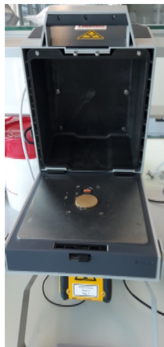
Abbildung 28: Messung der Proben mit EDXRF-Pistole
