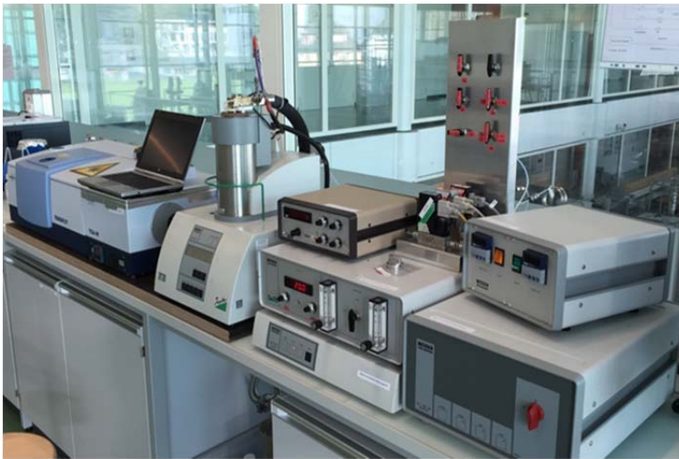
Abbildung 2 Messapparatur TGA mit FTIR
