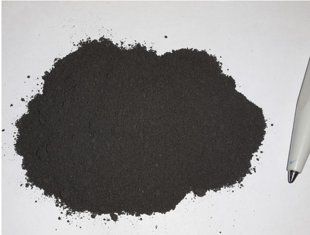
Abbildung 47 Filterasche A31 entnommen aus ESP nach Versuch bei 30 % Leistung
