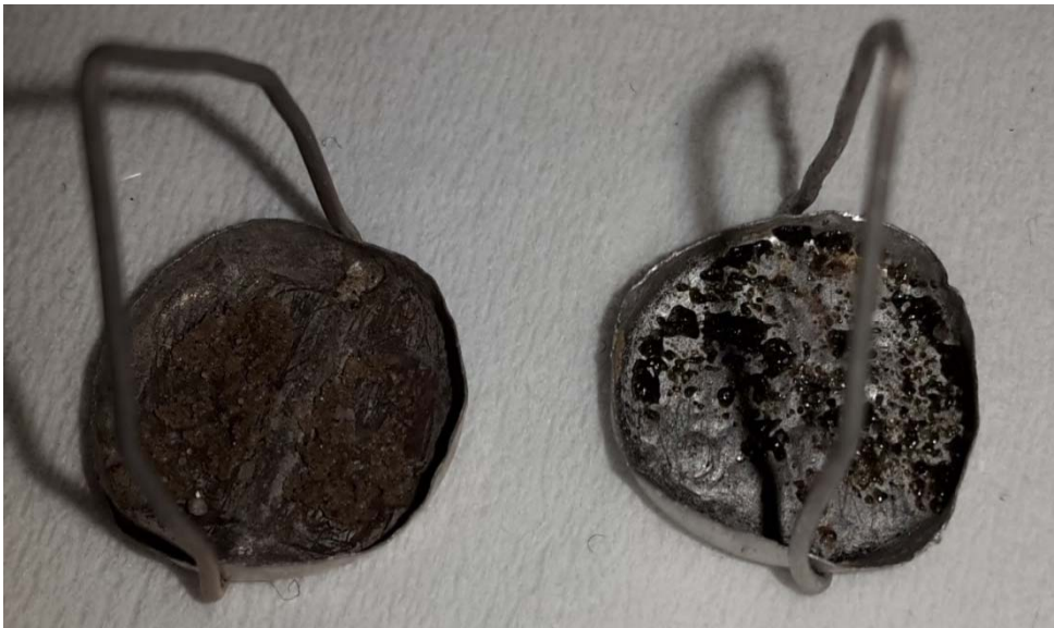
Abbildung 63: Platinprobenträger mit den Schlackenproben nach der TGA links unter Luft und rechts unter N_2 erhitzt
