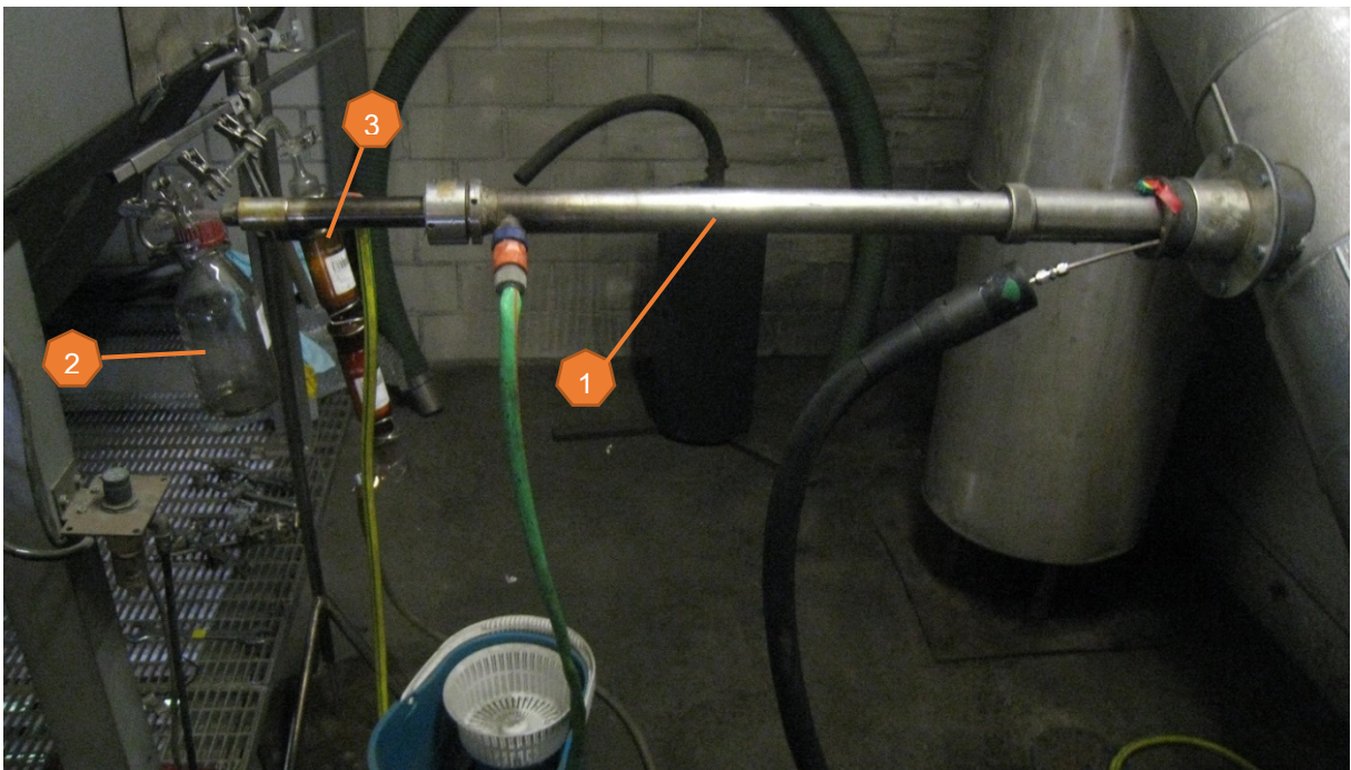
Abbildung 17: Probenahme für die PCDD/F-Messung durch Eurofins mit wassergekühlter Titan-Entnahmesonde (1), Waschflasche (2) und XAD-Filter (3)
