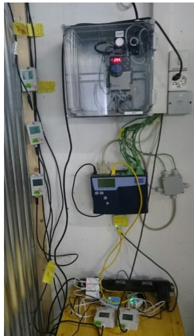
Abb. 36 Installation der Messtechnik a) Anschlüsse Thermoelemente an Datenlogger b) Flussmeter c) Feuchte/Temperaturlogger (2016) d) WLAN basierte Datenübertragung und Potentiometereinheit zur Regelung der Ventilator Drehzahl.
