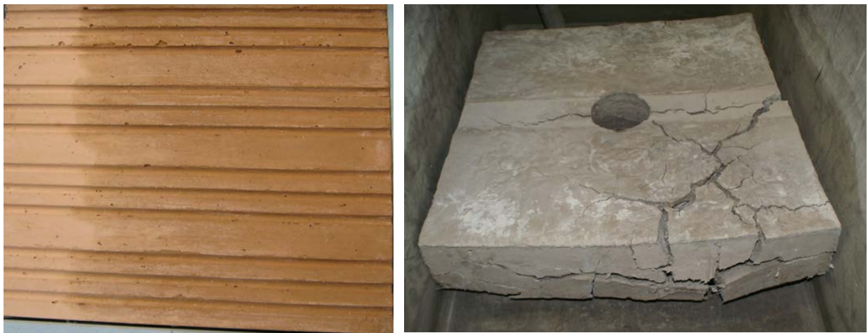
Abb. 9 Dauerhafte Platte links ( 40 \times 40 \times 30 \text{ mm}^3 ) und nicht beständige Platte ( 600 \times 600 \times 100 \text{ mm}^3 ) nach Trocknung bei 110^\circ\text{C} und anschliessender Dauerlagerung unter Wasser (verschiedene CSA-Zemente).
