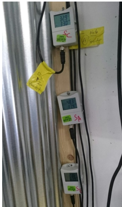
Abb. 36 Installation der Messtechnik a) Anschlüsse Thermoelemente an Datenlogger b) Flussmeter c) Feuchte/Temperaturlogger (2016) d) WLAN basierte Datenübertragung und Potentiometereinheit zur Regelung der Ventilator Drehzahl.
