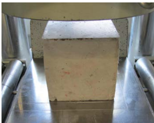
Abb. 17 Betonwürfel (Kantenlänge 150 mm) nach der Druckfestigkeitsprüfung.
