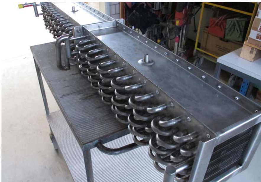
Abb. 28 Luftkühler (Kondensator) mit Kühlschlangen für den Wasserdurchfluss und stirnseitigem Lufteinlass (Länge 2 Meter).
