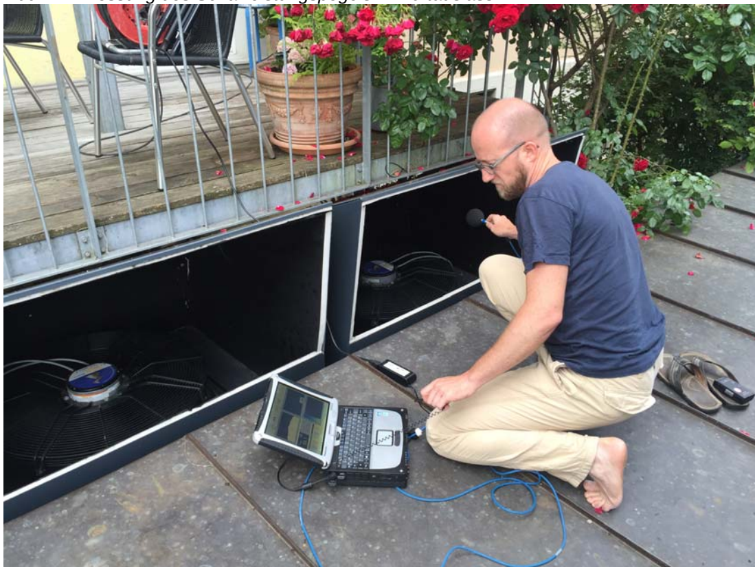
Abb. 11 Messung des Schalleistungspegels im Luftauslass
