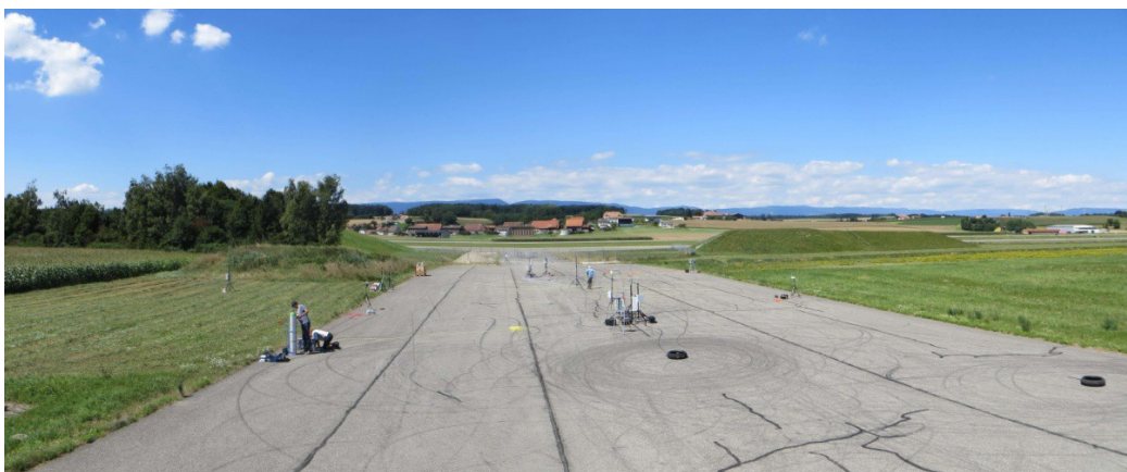
Abbildung 23: Bestimmung der Wiederfindungsrate von NH 3 mittels künstlicher Quelle in Payerne, Versuch vom 20.08.2013.
