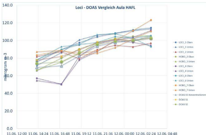
Abbildung 13: Vergleich der \text{NH}_3 Mittelwerte der 7 LOCI-Systeme mit den mittleren \text{NH}_3 miniDOAS Werten (Messung in der Aula der HAFL; Zeitangabe in UTC).
