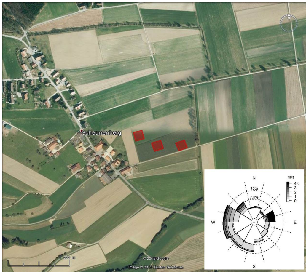
Abbildung A.65: Anordnung der Versuchsparzellen. Die Windrosengrafik zeigt die Frequenz der Windrichtung, sowie die dazugehörigen Windgeschwindigkeiten (in m/s) auf 1 m über Boden, welche über die gesamte Versuchsdauer gemessen wurden.
