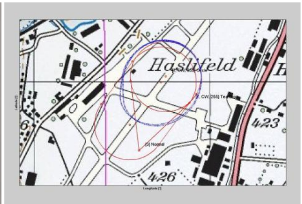
Links: UAV-Plattform (MTOW<30kg) während eines Validationsfluges. Rechts: Aufgezeichnete Flugmessdaten unter hohem Windeinfluss und limitiertem Rollwinkel
