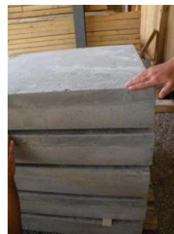
(von links nach rechts) UHPFRC Matrix mit Stahlfasern; Schalung der Versuchsplatten; Fertige Platten aus Beton mit einer Schicht aus UHPFRC.
