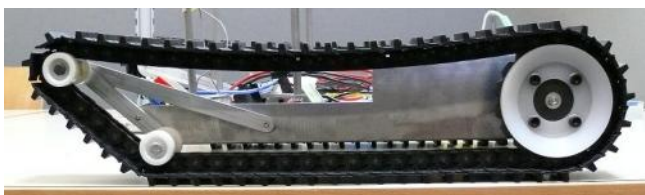
Demonstrator Fahrgerät eines Einweg-EOD-Roboters; vor der Integration einer Kamera und eines preisgünstiges Fernzündsystems
