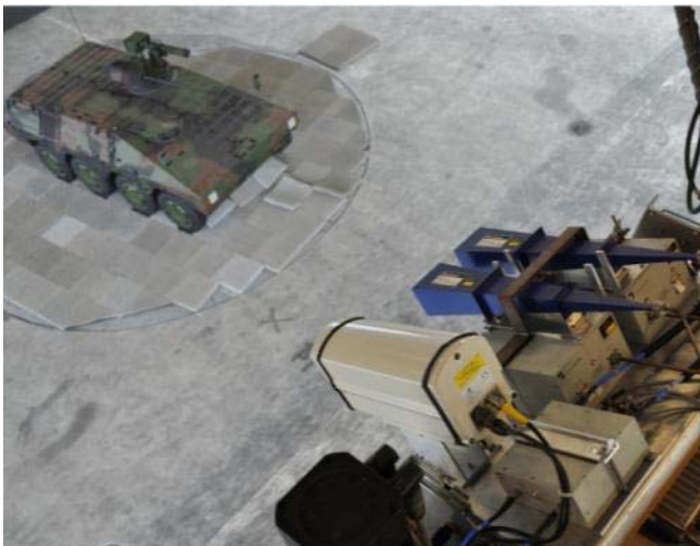
Radarvermessung des deutschen Attrappenfahrzeug STANDCAM in Thun im Jahr 2011.
