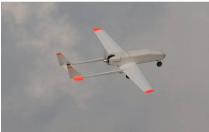
Links: UAV-Plattform (MTOW<30kg) während eines Validationsfluges. Rechts: Aufgezeichnete Flugmessdaten unter hohem Windeinfluss und limitiertem Rollwinkel
