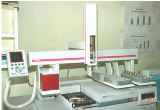
Abb. 1: HS-SPME / GC-MS-Gerät zur systematischen qualitativen Analyse auf flüchtige Zusatzstoffe (links) und Ammoniakselektive Elektrode zum Nachweis von Ammoniak und Harnstoff (rechts)
