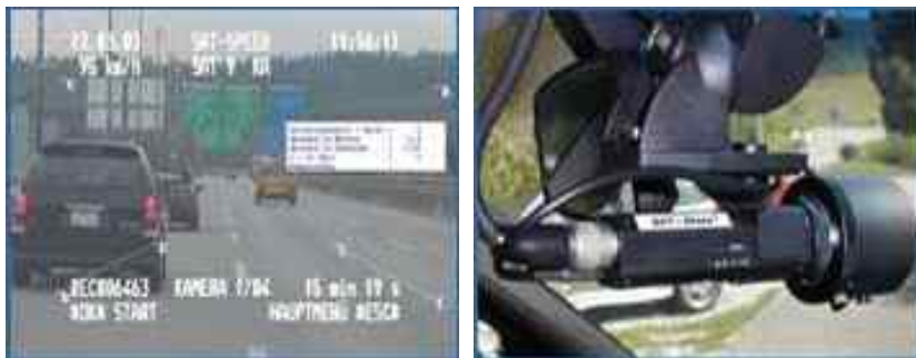
Abbildung 32: Beispiel einer Nachfahrkontrolle, Kamera hinter Windschutzscheibe 47
