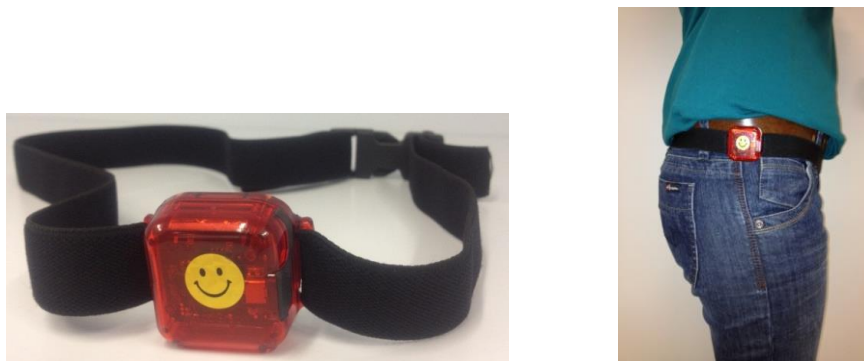
Abbildung 2. Actigraph GT3X+ Akzelerometer (Bild links), getragen auf der rechten Hüfte (Bild rechts)
