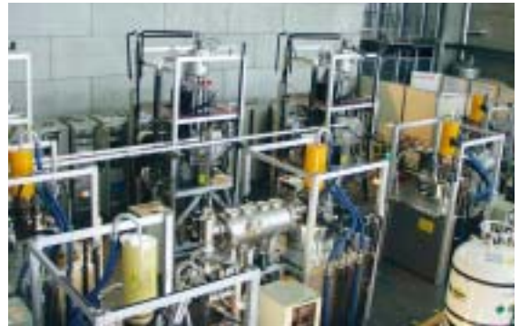
Gyrotrons de 83 et 118 GHz dans la halle TCV
