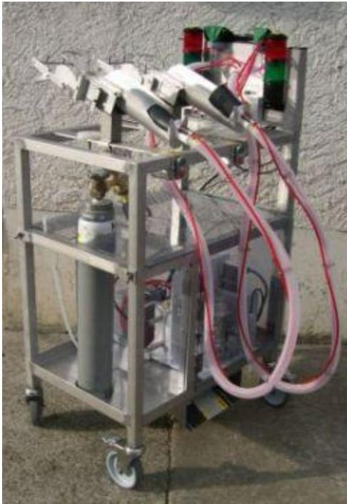
Abbildung 3: Gerät zur Inhalationsnarkose für die Ferkelkastration der Firma Agrocomp.
