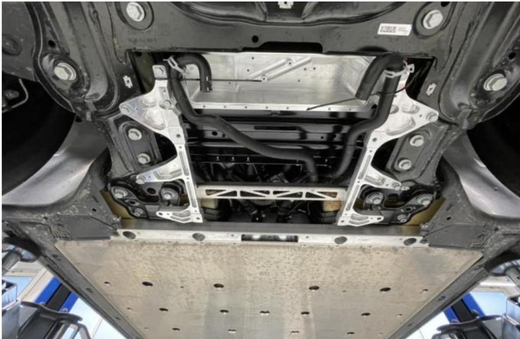
Abbildung 15: Unterboden mit installiertem Montagerahmen und vorbereiteten Kühlschläuchen
