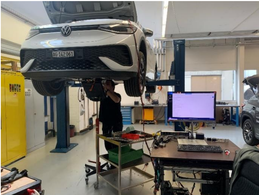
Abbildung 22: Modifikation am WiTricity-Fahrzeugempfänger im Eniwa Fahrzeug bei der Empa
