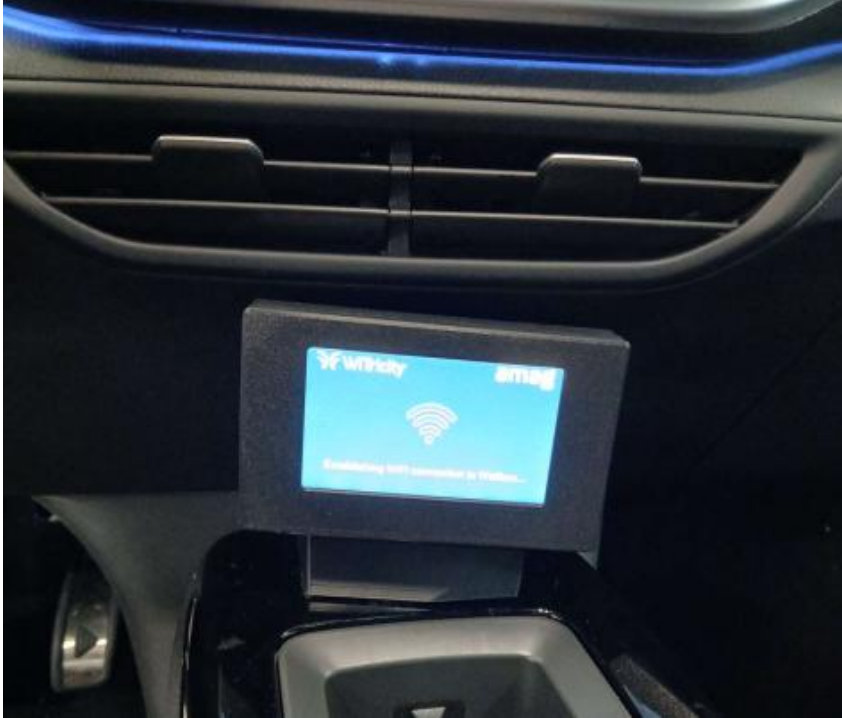
Abbildung 32: Display zur Visualisierung der Einparkhilfe auf Mittelkonsole
