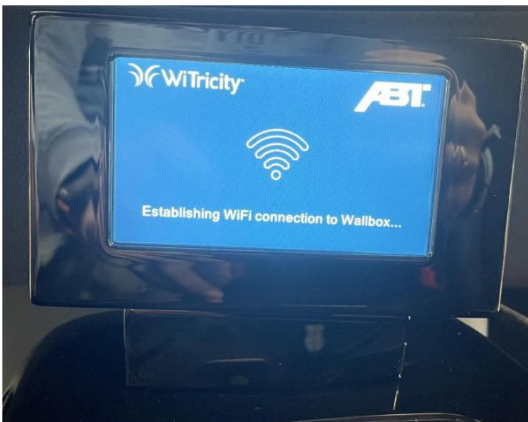
Abbildung 21: Zusätzliches Display zur Visualisierung des Systemzustands
