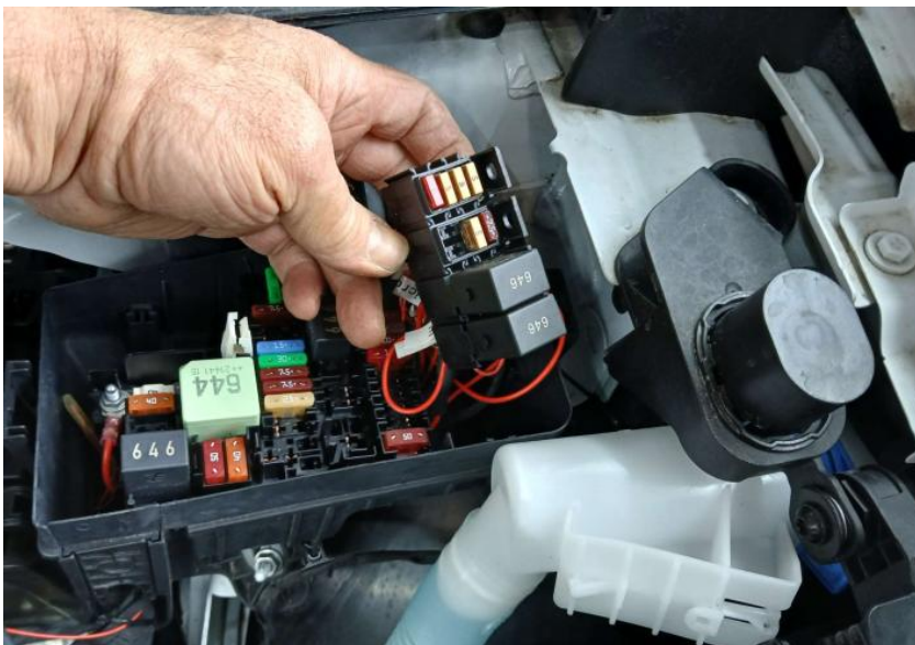
Abbildung 35: Zusätzliche Sicherungshalter im vorderen Sicherungskasten
