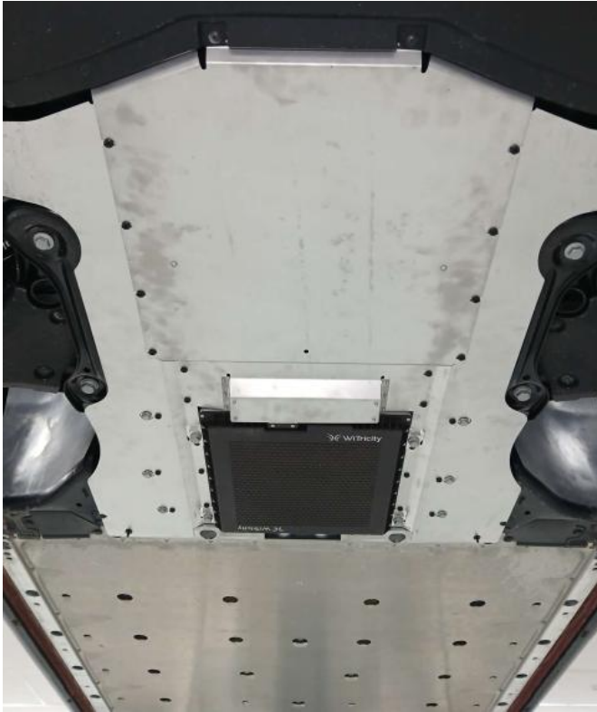
Abbildung 30: Installierte Fahrzeugeinheit (VA) am Unterboden
