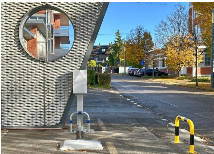
Abbildung 47: Kabellose Ladestation auf dem Campus der Empa Dübendorf
