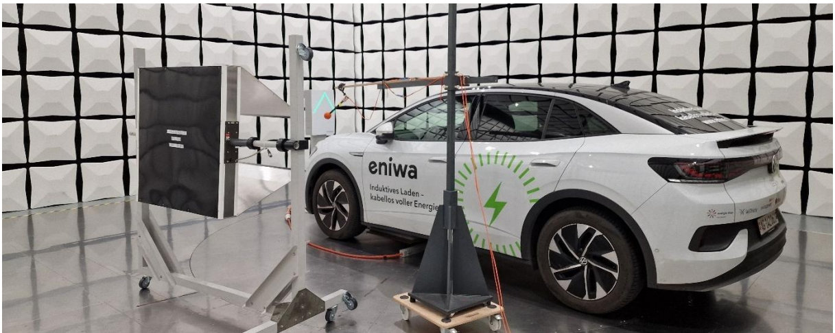
Abbildung 38: Fahrzeug Nr. 1 im EMV-Labor mit Feldgenerator zur Prüfung der Immunität
