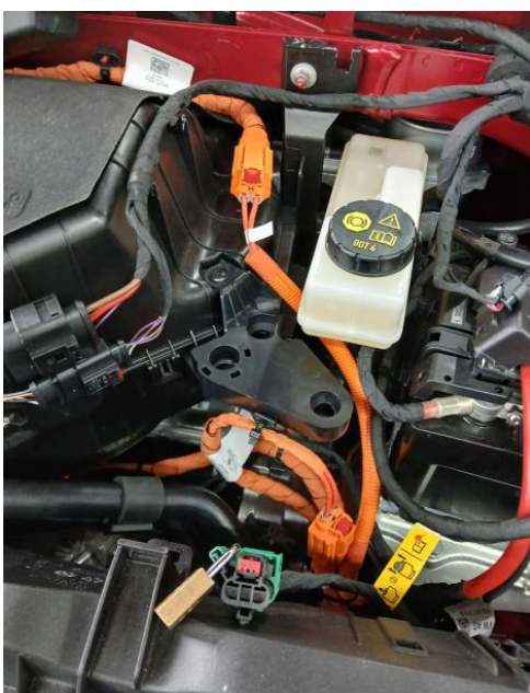
Abbildung 33: neue elektrische Leitungen in orange
