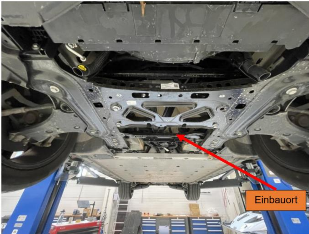
Abbildung 14: vorbereiteter Unterboden vor der Montage der Fahrzeugeinheit (Vehicle Assembly)
