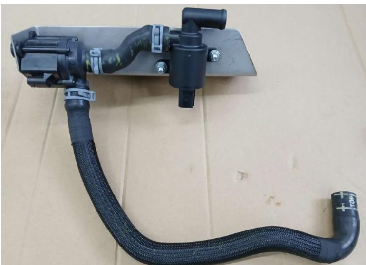
Abbildung 31: Neue Halterung der Kühlmittelpumpe und des Magnetventils
