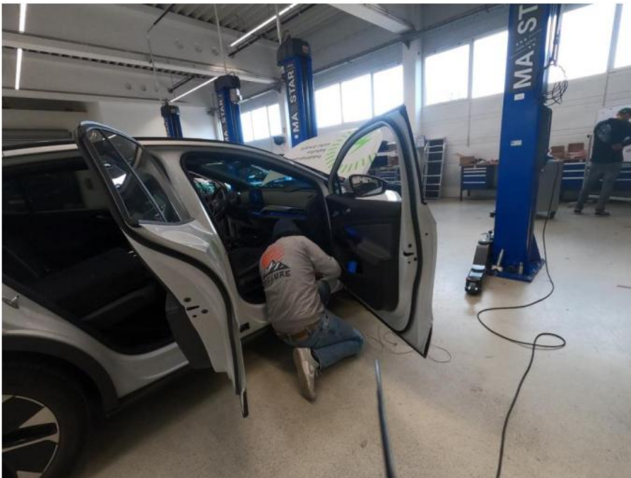
Abbildung 19: Installation Kabelbaum im Fahrzeuginneren
