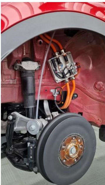
Abbildung 37: Neue Abzweigdose des Hochvoltsystems
