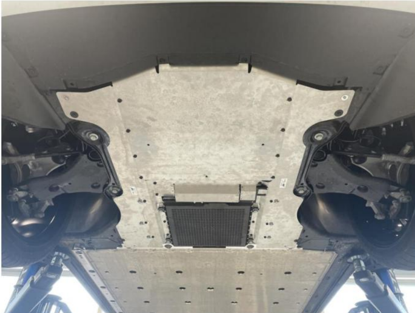
Abbildung 16: Fertig installierter Unterboden inkl. Schirmbleche
