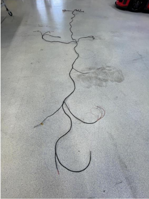
Abbildung 18: Kabelbaum Niedervoltsystem (12 V) vor Fahrzeuginstallation
