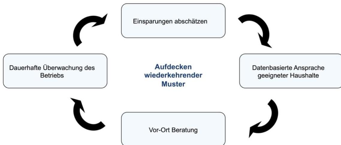
**Grafik 8:** Kreislauf der Wärmepumpen-Überwachung auf Basis von Smart-Meter-Daten.
