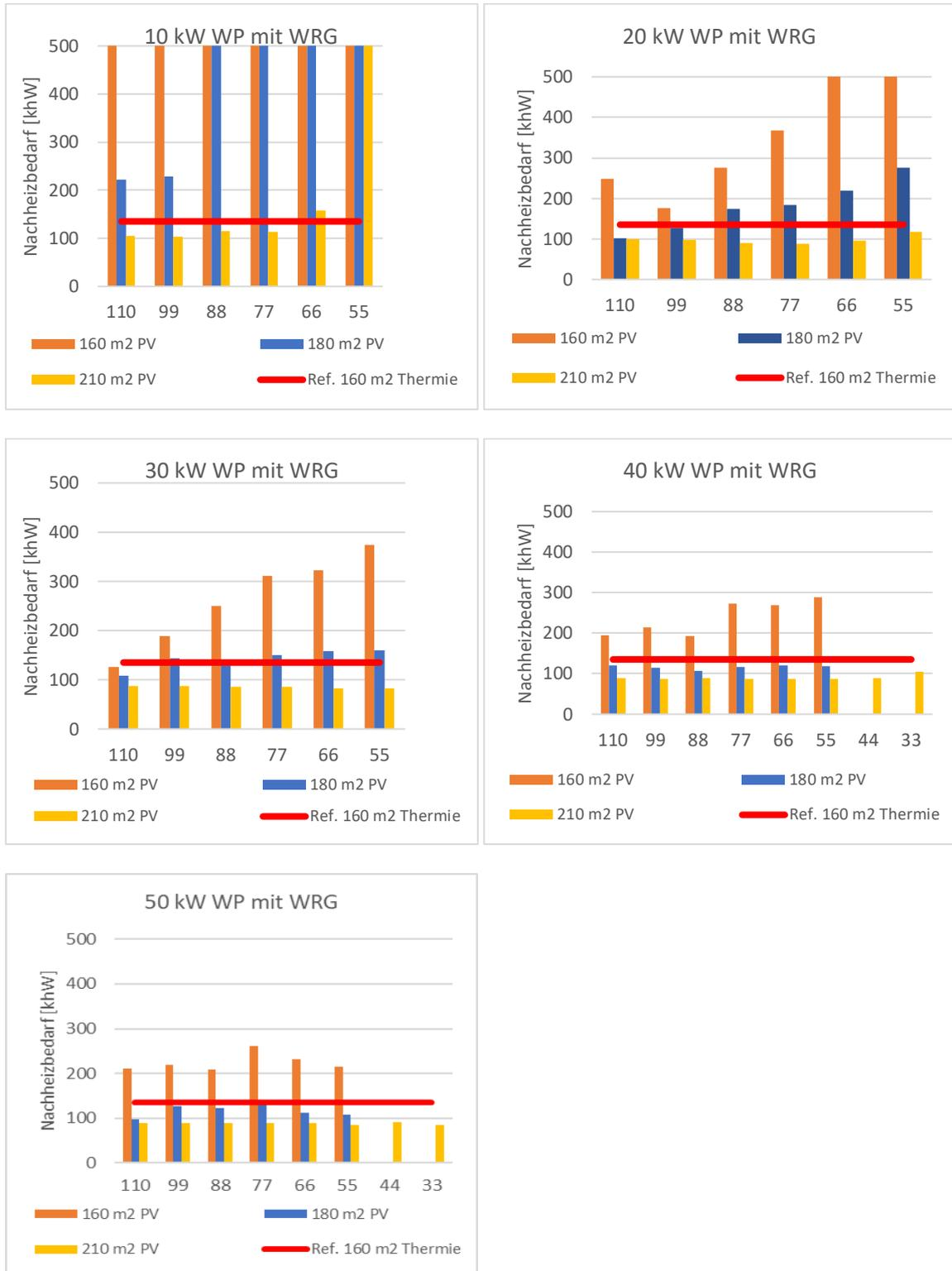
Abbildung 25: Nachheizbedarf elektrisch ab Netz bei unterschiedlicher Wärmepumpen- und Speichergößen bei der Verwendung der Fundamentplatte als Quelle mit Duschwasserwärmerückgewinnung.
