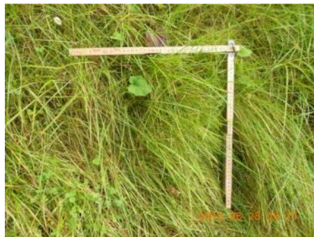
Abbildung 30: Vlies vom Typ 90 Bu 10 Fö 500 gm -2 Trägermaterial PP: Zustand fünf Monate nach Einbau.
