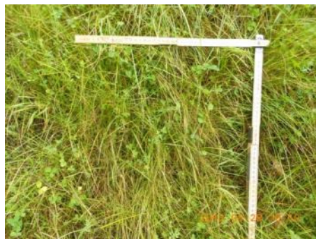
Abbildung 28: Vlies vom Typ 70 Fö 30 Bu 350 gm -2 Trägermaterial Jute: Zustand fünf Monate nach Einbau. Links oberes, rechts unteres Ende des Vlieses.
