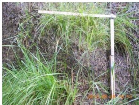
Abbildung 34: Vlies vom Typ 70 Fö 30 Bu 350 gm -2 Trägermaterial PP: Zustand fünf Monate nach Einbau.
