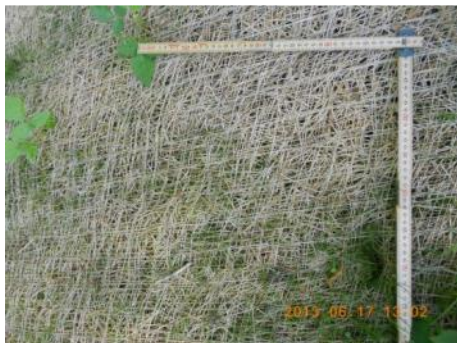
Abbildung 17: Vlies vom Typ 70 Fö 30 Bu 350 gm -2 Trägermaterial Jute: Zustand zweieinhalb Monate nach Einbau. Links oberes, rechts unteres Ende des Vlieses.
