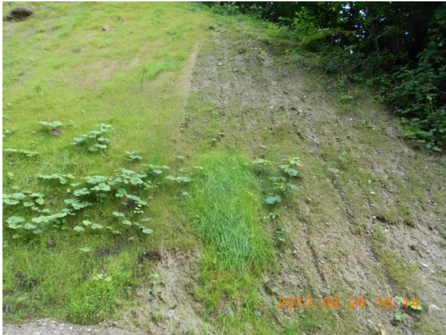
Abbildung 37: Versuchsfeld (links) und Kontrollfeld (rechts). Die Vegetation auf der Versuchsfeld ist deutlich besser entwickelt.
