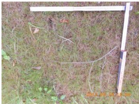
Abbildung 33: Vlies vom Typ 90 Fö 10 Bu 500 gm -2 Trägermaterial PP: Zustand fünf Monate nach Einbau.
