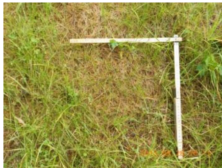
Abbildung 31: Vlies vom Typ 90 Fö 10 Bu 500 gm -2 Trägermaterial PP: Zustand fünf Monate nach Einbau.
