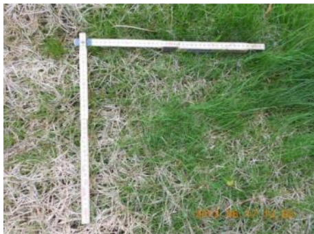
Abbildung 18: Vlies vom Typ 70 Fö 30 Bu 350 gm -2 Trägermaterial PP: Zustand zweieinhalb Monate nach Einbau. Links oberes, rechts unteres Ende des Vlieses.
