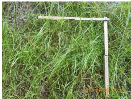
Abbildung 33: Vlies vom Typ 90 Fö 10 Bu 500 gm -2 Trägermaterial PP: Zustand fünf Monate nach Einbau.
