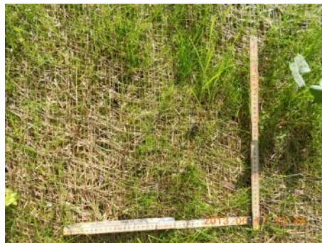
Abbildung 17: Vlies vom Typ 70 Fö 30 Bu 350 gm -2 Trägermaterial Jute: Zustand zweieinhalb Monate nach Einbau. Links oberes, rechts unteres Ende des Vlieses.
