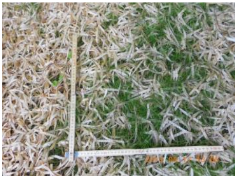
Abbildung 20: Vlies vom Typ 90 Fö 10 Bu 500 gm -2 Trägermaterial PP: Zustand zweieinhalb Monate nach Einbau. Links oberes, rechts unteres Ende des Vlieses.
