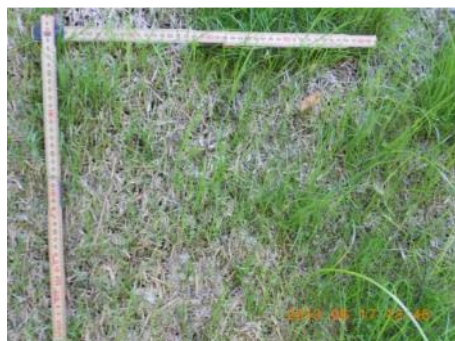
Abbildung 22: Vlies vom Typ 90 Fö 10 Bu 500 gm -2 Trägermaterial PP: Zustand zweieinhalb Monate nach Einbau. Links oberes, rechts unteres Ende des Vlieses.
