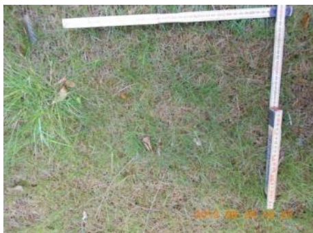
Abbildung 34: Vlies vom Typ 70 Fö 30 Bu 350 gm -2 Trägermaterial PP: Zustand fünf Monate nach Einbau.
