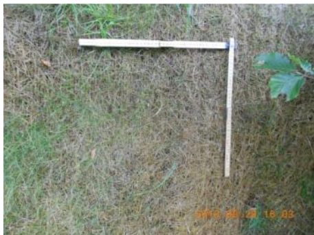
Abbildung 30: Vlies vom Typ 90 Bu 10 Fö 500 gm -2 Trägermaterial PP: Zustand fünf Monate nach Einbau.
