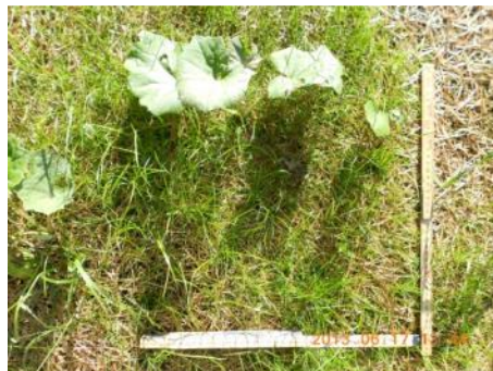
Abbildung 18: Vlies vom Typ 70 Fö 30 Bu 350 gm -2 Trägermaterial PP: Zustand zweieinhalb Monate nach Einbau. Links oberes, rechts unteres Ende des Vlieses.
