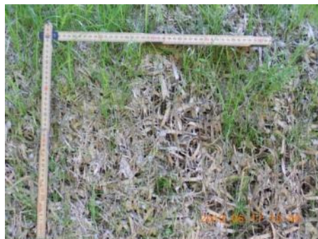
Abbildung 21: Wirrgelege 70 Fö 30 Bu 450 gm -2 Trägermaterial PP: Zustand zweieinhalb Monate nach Einbau. Links oberes, rechts unteres Ende des Vlieses.
