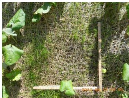
Abbildung 15: Vlies vom Typ 70 Bu 30 Fö 350 gm -2 Trägermaterial Jute: Zustand zweieinhalb Monate nach Einbau. Links oberes, rechts unteres Ende des Vlieses.
