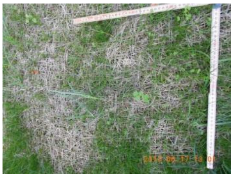
Abbildung 15: Vlies vom Typ 70 Bu 30 Fö 350 gm -2 Trägermaterial Jute: Zustand zweieinhalb Monate nach Einbau. Links oberes, rechts unteres Ende des Vlieses.
