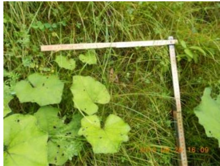
Abbildung 26: Vlies vom Typ 70 Bu 30 Fö 350 gm -2 Trägermaterial Jute: Zustand zweieinhalb Monate nach Einbau. Links oberes, rechts unteres Ende des Vlieses.
