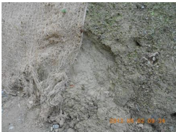
Abbildung 13: Erosionsstellen am Übergang zwischen Holzwollevlies und Kontrollfläche.
