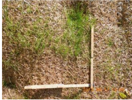
Abbildung 20: Vlies vom Typ 90 Fö 10 Bu 500 gm -2 Trägermaterial PP: Zustand zweieinhalb Monate nach Einbau. Links oberes, rechts unteres Ende des Vlieses.
