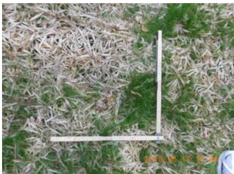
Abbildung 21: Wirrgelege 70 Fö 30 Bu 450 gm -2 Trägermaterial PP: Zustand zweieinhalb Monate nach Einbau. Links oberes, rechts unteres Ende des Vlieses.
