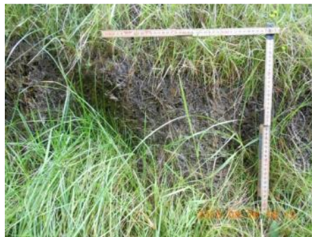
Abbildung 32: Wirrgelege 70 Fö 30 Bu 450 gm -2 Trägermaterial PP: Zustand fünf Monate nach Einbau.
