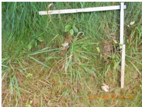
Abbildung 32: Wirrgelege 70 Fö 30 Bu 450 gm -2 Trägermaterial PP: Zustand fünf Monate nach Einbau.
