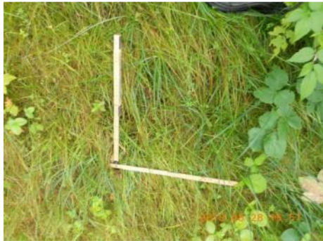
Abbildung 26: Vlies vom Typ 70 Bu 30 Fö 350 gm -2 Trägermaterial Jute: Zustand zweieinhalb Monate nach Einbau. Links oberes, rechts unteres Ende des Vlieses.
