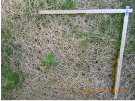
Abbildung 20: Vlies vom Typ 90 Fö 10 Bu 500 gm -2 Trägermaterial PP: Zustand zweieinhalb Monate nach Einbau. Links oberes, rechts unteres Ende des Vlieses.
