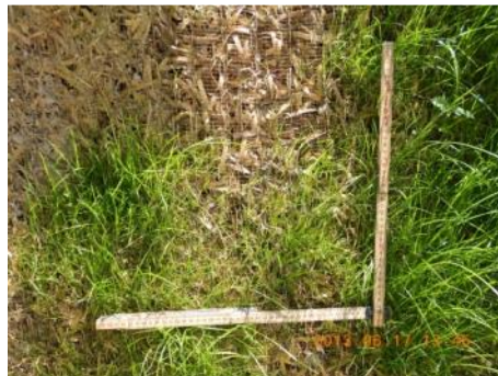
Abbildung 20: Vlies vom Typ 90 Fö 10 Bu 500 gm -2 Trägermaterial PP: Zustand zweieinhalb Monate nach Einbau. Links oberes, rechts unteres Ende des Vlieses.
