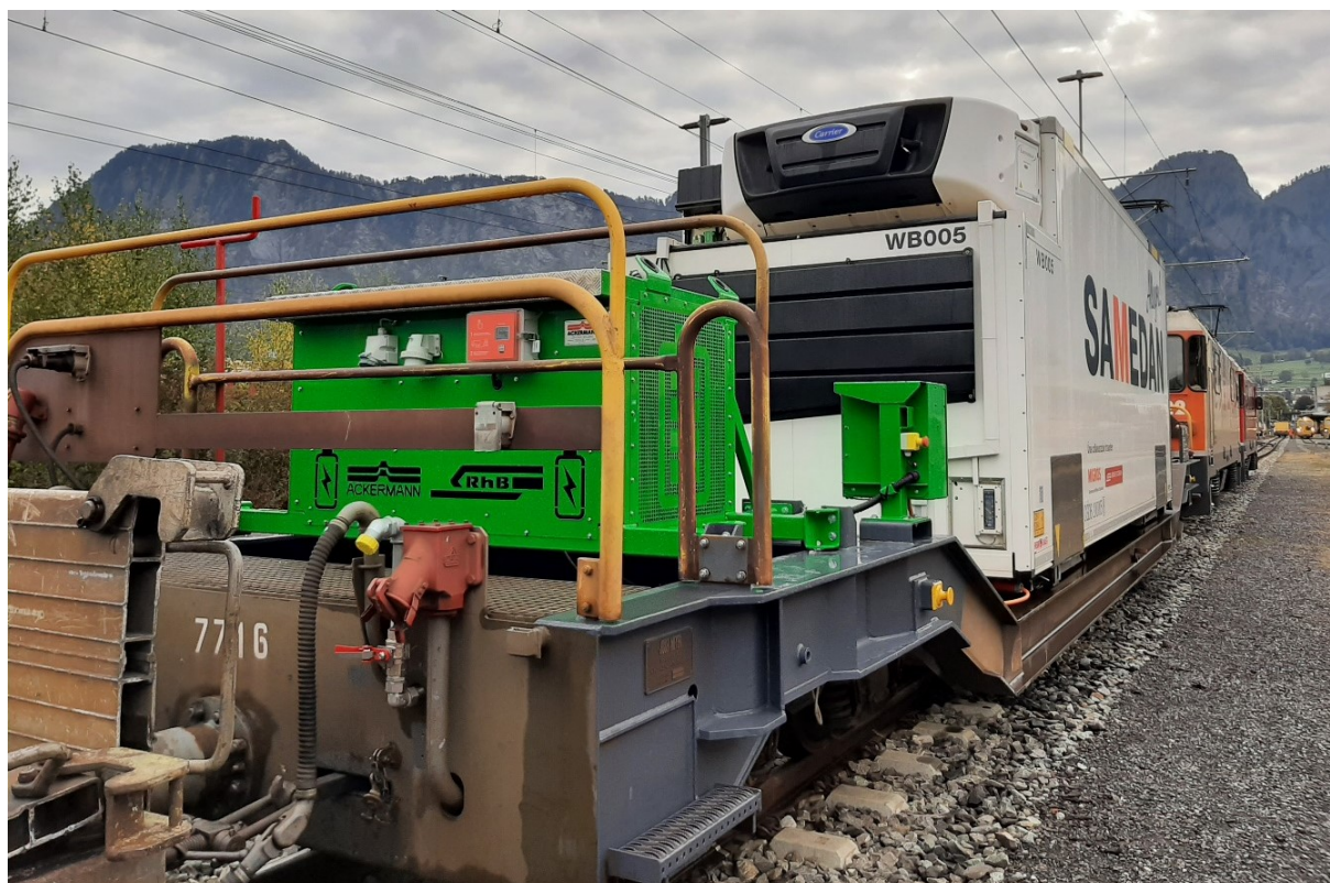
Abbildung 1: Powerpack auf Containertragwagen mit Wechselbehälter
