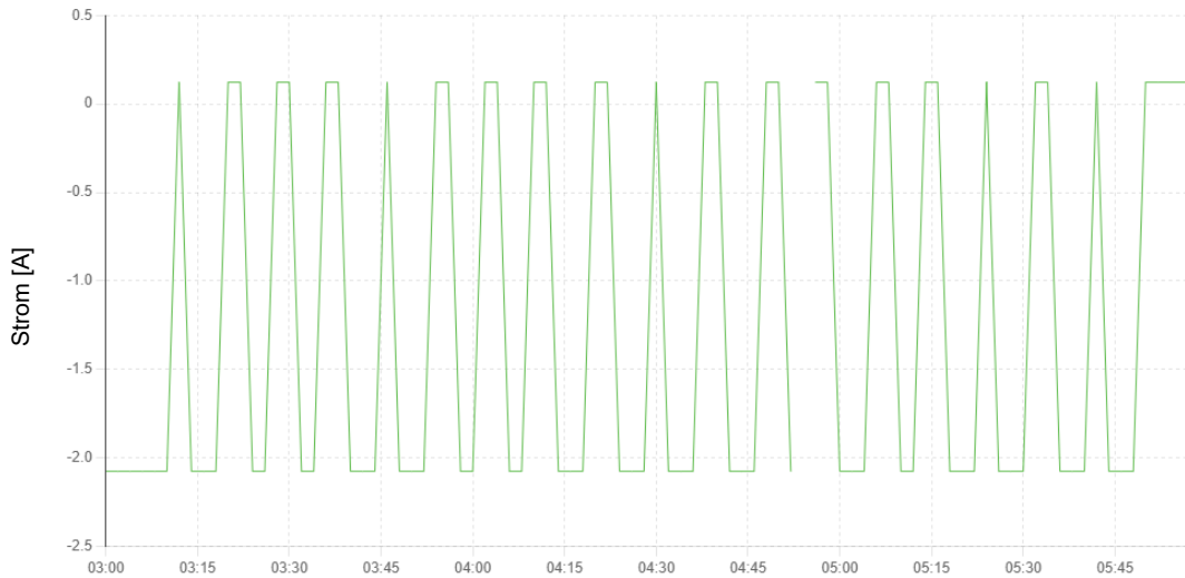
Abbildung 6: Stromverbrauch Container im Heizmodus
