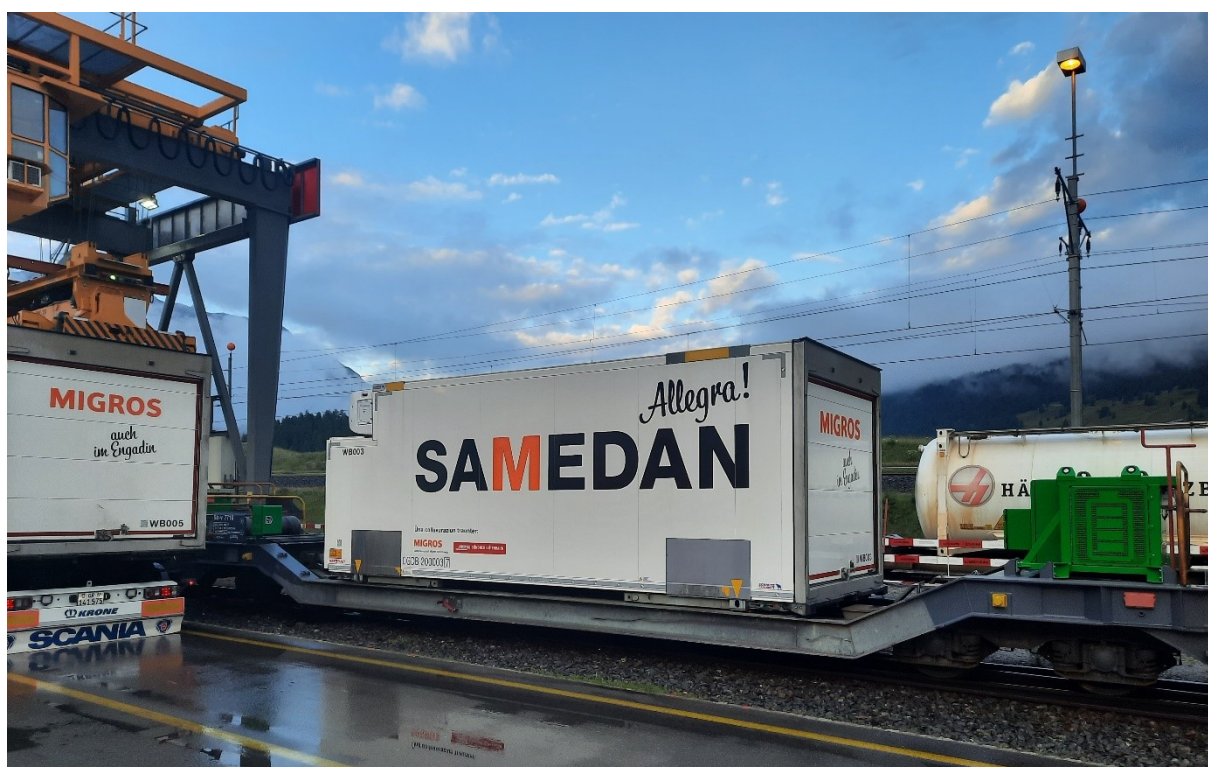
Abbildung 2: Powerpack Containertragwagen im Güterumschlagzentrum Samedan
