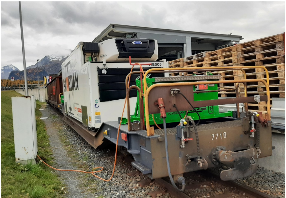
Abbildung 3: Powerpack an der Ladesteckdose
