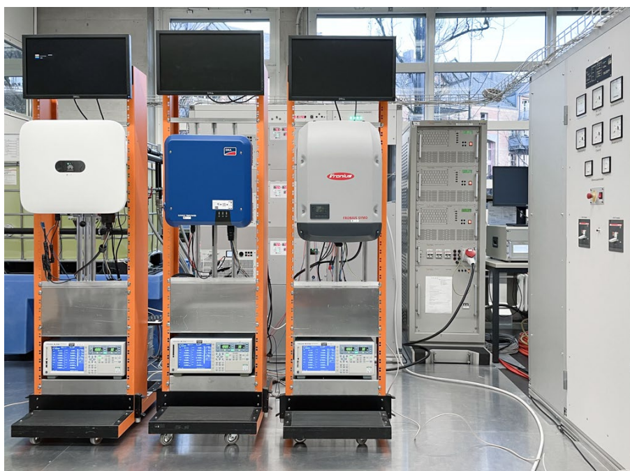
Abbildung 4 Situation im Wechselrichterlabor der BFH mit den 3 getesteten Wechselrichtern. Im Hintergrund sind die DC- und AC-Quellen ersichtlich. Quellenangabe: BFH IEM PV-Labor
