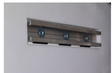
Abbildung 6: Beispiel einer an der Seitenwand montierten C-Schiene
