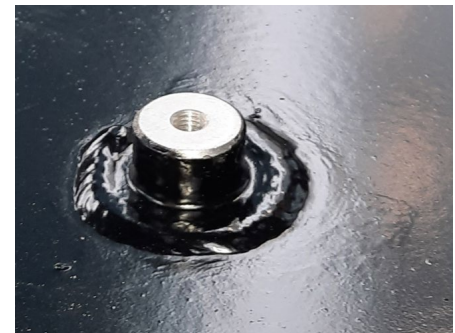
Abbildung 2: Reales Erdungsauge in der Montagehalle von Stadler Rail (ohne Dämmmaterial)
