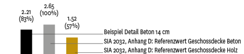
Fig. 16: graue Treibhausgasemissionen der Betondecke des Fallbeispiels bezogen auf Referenzwerte SIA 2032, Anhang D
