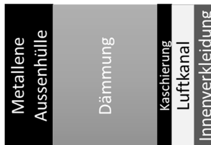
Abbildung A1: Schematischer Aufbau einer Zugwand
