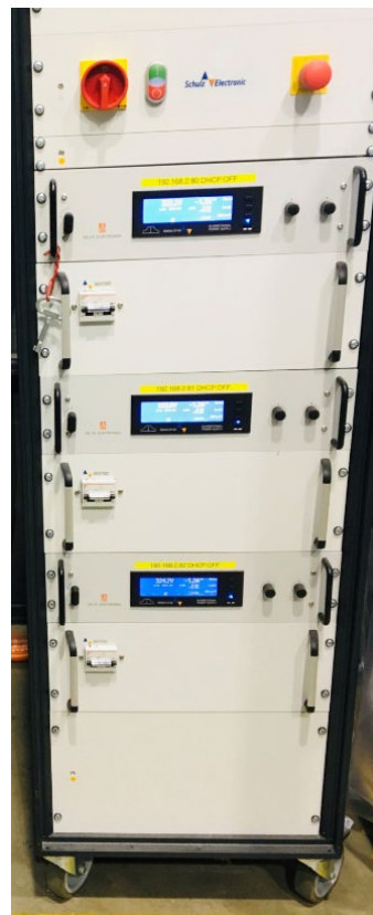
Abbildung 33: Haushaltsstrom Emulator von Schulz Electronic mit Delta Geräten
