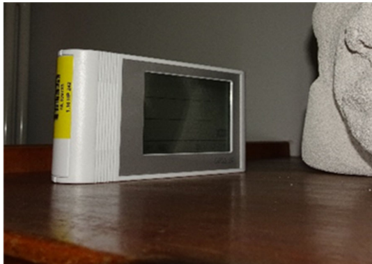
Abbildung 12: CO 2 -, Lufttemperatur- und Luftfeuchte- Logger
