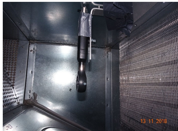
Abbildung 15: Messung mit dem Anemometer (ZH_3)
