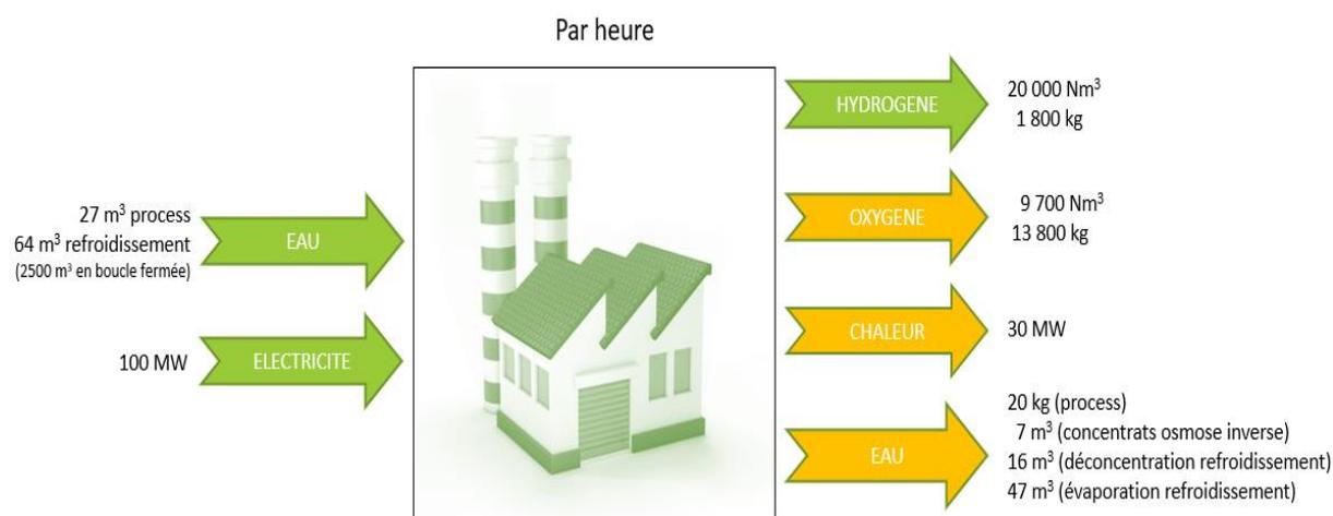
Figure 6 : Schéma illustrant les intrants et extrants des unités en projet à Dunkerque et à Port-Jérôme sur Seine (Source : H2V Industry, 2018)
