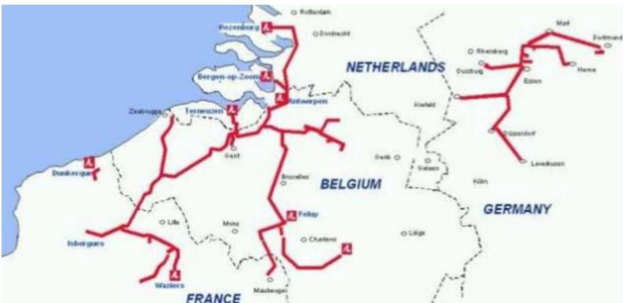
Figure 20 : Réseaux de pipelines hydrogène d'Air Liquide du Nord de l'Europe [17]
