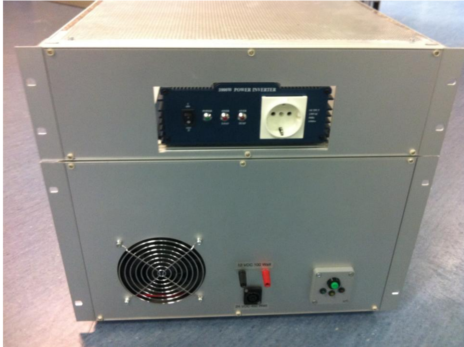
Abb. 2. Frontansicht des 19-Zoll Rack Systems. Bedienpanel, Schnittstellen 12 VDC, 24 VDC und 230 VAC.
