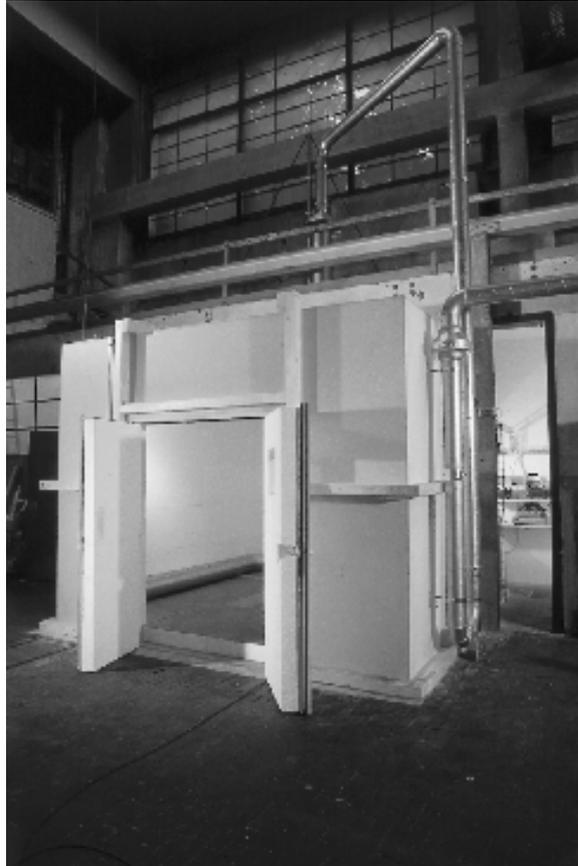
Versuchsaufbau im *Labor für nachhaltige Energiesysteme* des Ökozentrums Langenbruck für die simultane Erfassung der Wirkungsgrade und Emissionen von Feuerstätten im Kalorimeterraum und Verdünnungstunnel (ISO/DIS 13336) sowie im Abgas (CEN/prEN 13240)
