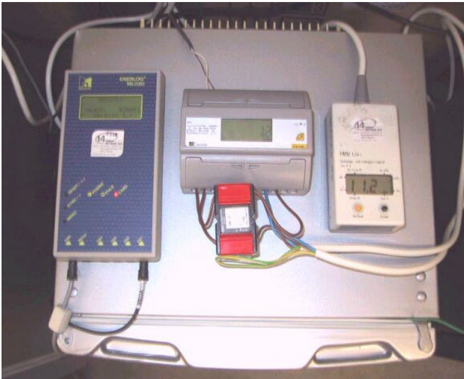
Fig. 8 Datenlogger, Energiezähler mit Stromwandler, Kontrollzähler (EMU 1.24)
