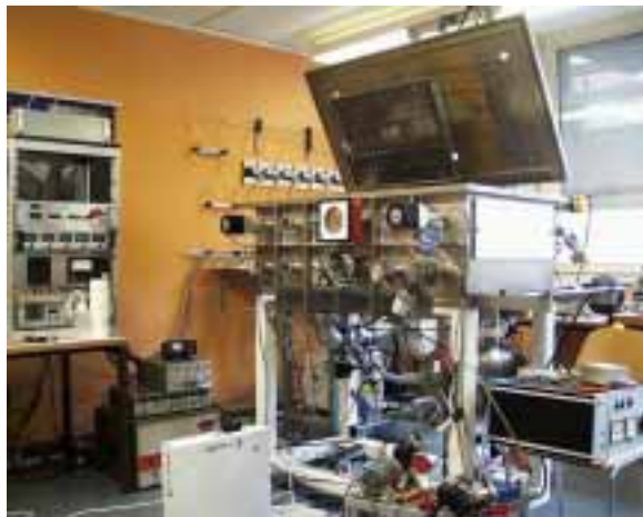
ill. 1: Réacteur roll-to-roll chez VHF-Technologies Photo: VHF-Technologies
