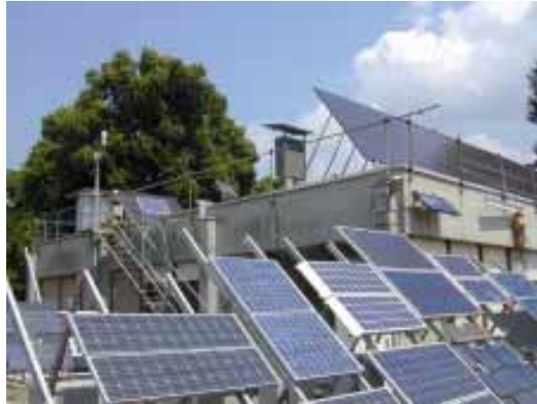
ill. 3: Banc d'essai pour modules PV au LEEE-TISO Photo: NET SA
