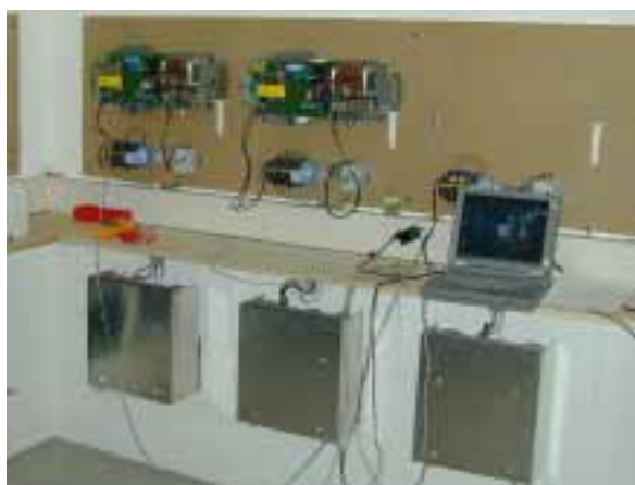
ill. 5: Prototype d'onduleur à nœuds LON Photo: NET SA
