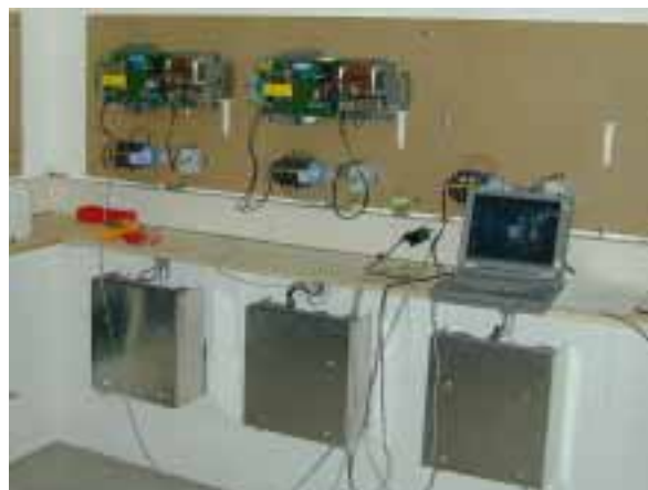
Bild 5: Wechselrichterprototyp mit LON Knoten, Foto: NET AG
