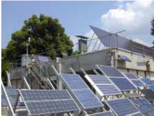
Bild 3: Teststand für Modulprüfungen am LEEE-TISO Foto: NET AG
