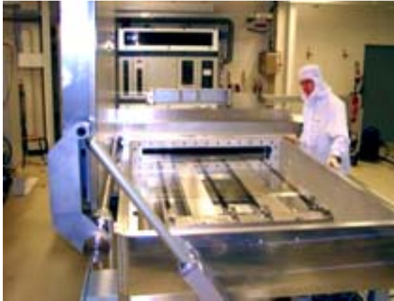
Figure 1: Installation industrielle KAI de dépôt à plasma (Photo: Unaxis)
