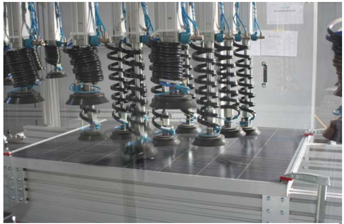
Figur 6: Mechanische Belastungstests für Modulprüfungen für IEC-Tests (Quelle: SUPSI).
