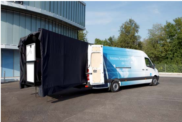
Figur 7: Mobiles Messlabor für Solarmodule (Quelle: EKZ).
