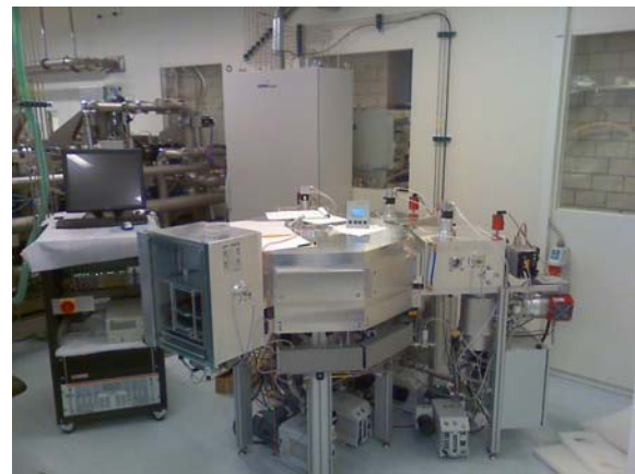
Figur 2: Neue PECVD-Cluster-Depositionsanlage zur Entwicklung der Heteroübergangs-Solarzelle (Quelle: IMT).
