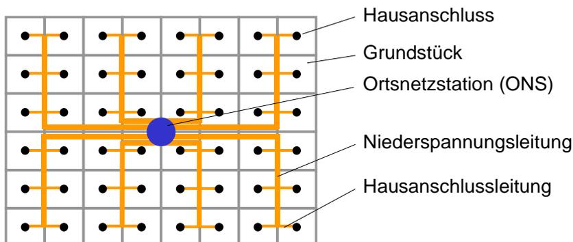
Abbildung 17-5: Optionale Grundformen der Netzstruktur für Strom-Modellnetze
