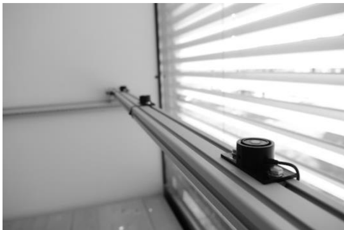
A FIG. 55 Raumbeleuchtungsstärkescanner mit Messkopf
