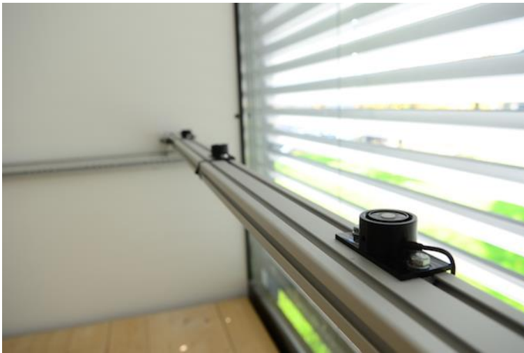
FIG. 10 Beleuchtungsstärkesensorkopf des Raumscanners
