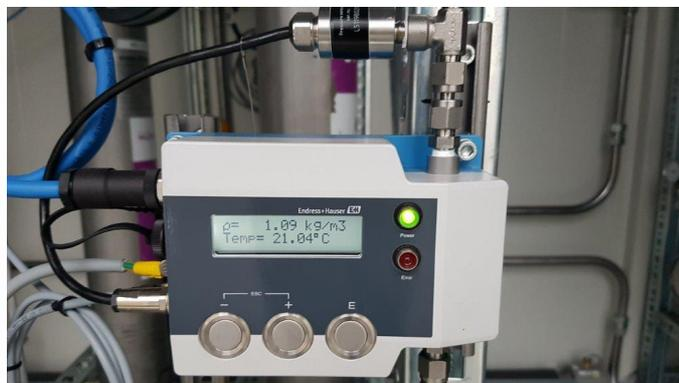
Abbildung 11: Nanomass von TrueDyne (Endress+Hauser) mit Vor-Ort-Anzeige und drei Bedientasten für die Inbetriebnahme
