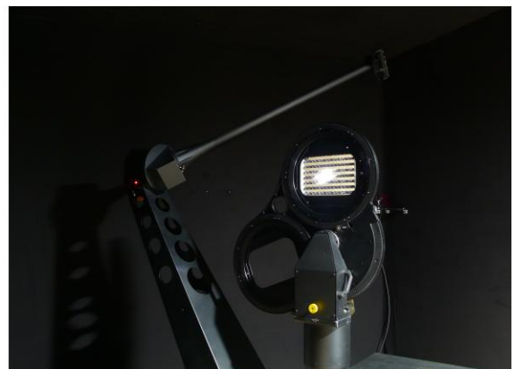
Abb. 1 (links): Die BSDF ist abhängig von der Richtung zur Lichtquelle (rot, \theta_i , \phi_i ) und der ausgehenden Richtung (grün, \theta_s , \phi_s ) des reflektierten oder transmittierten Lichts. Abb. 2 (rechts): Die neue Probenhalterung mit installierter Probe eines Sonnenschutzelements.
