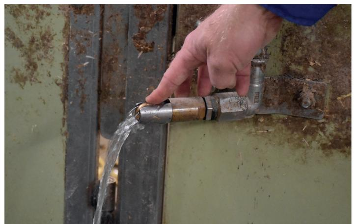
Abb 7: Kontrolle der Durchflussrate
