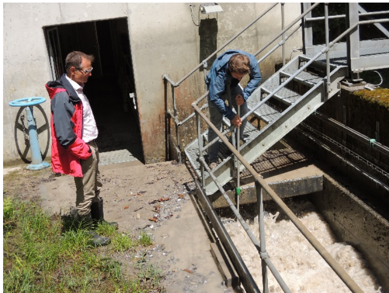
Abbildung 37: Probenahme im Oberwasser des Coanda-Rechens an der Samina, Frastanz (AT) beim ca. 10-jährlichen geschiefbeführenden Hochwasser vom 17.6.2016
