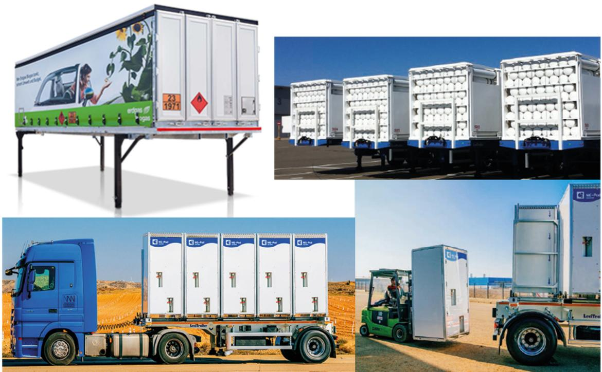
Bilder: mögliche CNG-Transport-Systeme unterschiedlicher Hersteller für den Transport von Biogas
