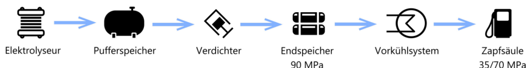
Abb. 1 Hauptkomponenten der Wasserstoff-Anlage an der Empa
