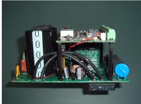
Abb 171 zeigt die Elektronik eines 370W Umformers für Normmotoren.
