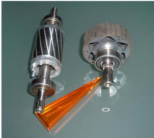
**Abb. 163: Mit dem Wechsel des Kurzschlussläufers zu einem Permanent – Magnet – Rotor lassen sich elegant Verluste umgehen !!!**
