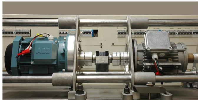
Abb. 144: Mechanische Kopplung der Maschinen ASM ↔ BLDC
