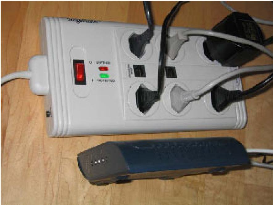
Figur 5: Steckerleiste mit Kippschalter und Überspannungsschutz
