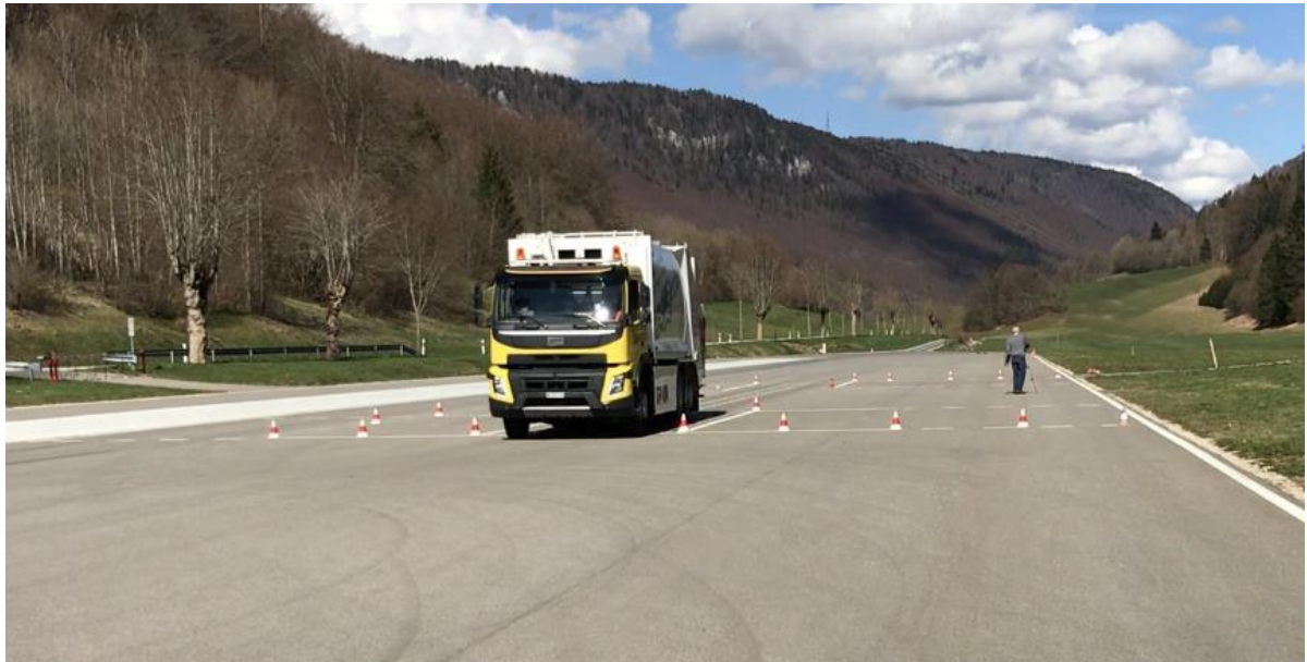
Abbildung 39: Der E-LKW bei der Lärmmessung (Durchfahrtsmessung). Dynamic Test Center, Vauffelin.
