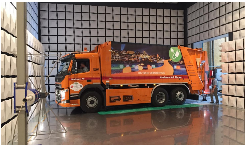
Abbildung 54: Der E-LKW 1 bei der EMV Messung.
