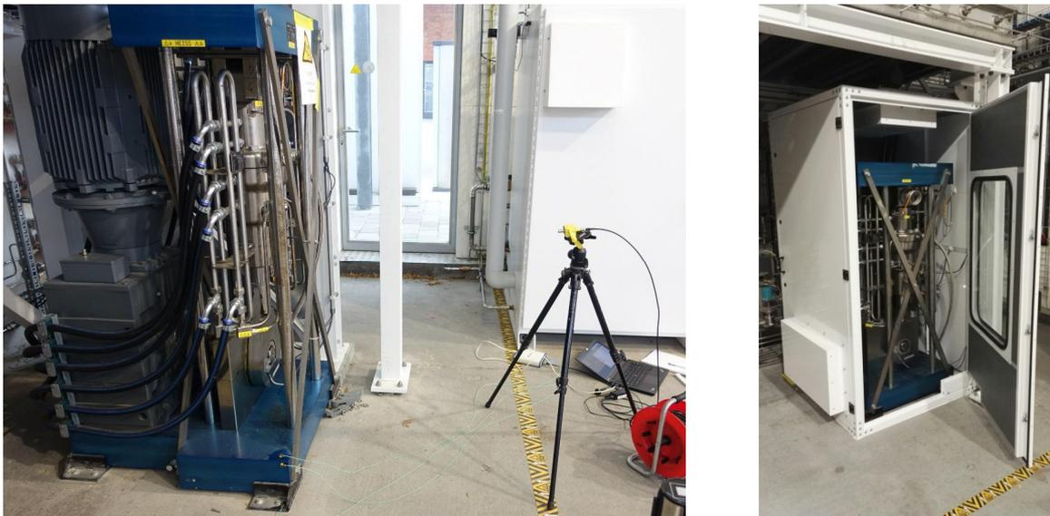
Abb. 2 Schalldruckmessung (links) und Verdichter mit Kapselung (rechts)
