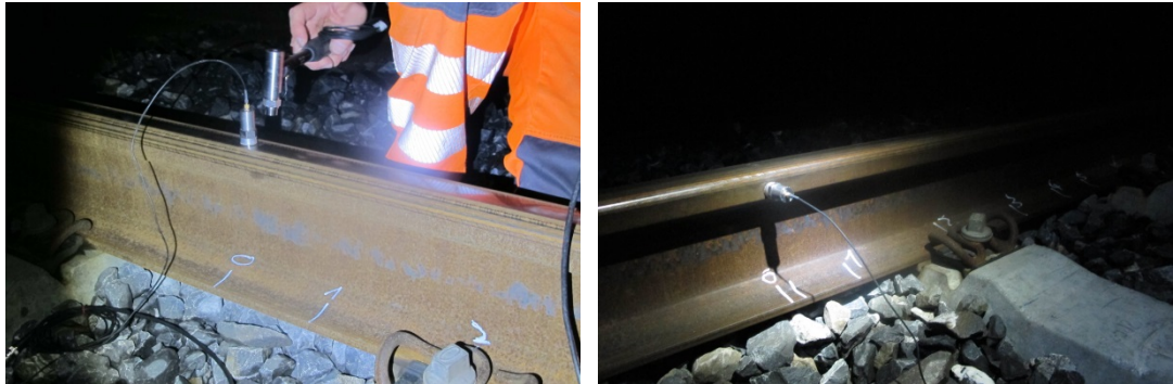
Abbildung 3. Messung der Schienenabklingrate vertikal (links) und horizontal (rechts).
