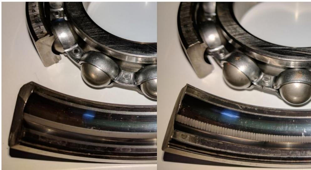
Abbildung 9: Lagerschädigung. Links «Graue Spur», rechts Riffelbildung
