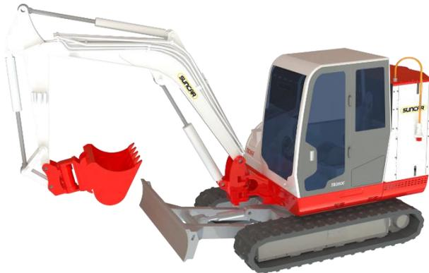
Abbildung 38: CAD Rendering des 7-t-Elektrobaggers
