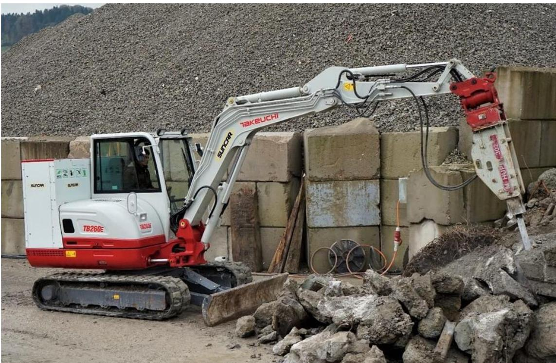
Abbildung 6: 7-t-Elektrobagger
