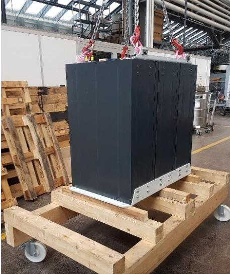
Abbildung 36: Vormontierte Batterietröge
