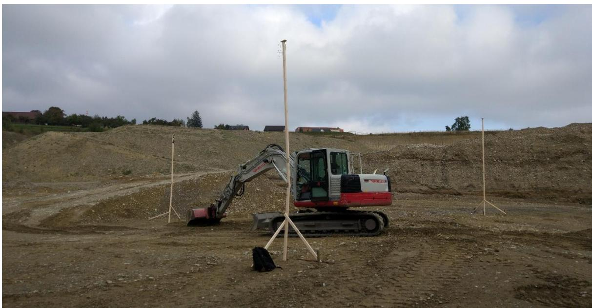
Abbildung 53: Lärmmessungen, Messungen des A-bewerteten Schallpegels an drei Messpunkten
