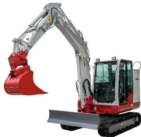
Abbildung 39: Realer 7-t-Elektrobagger
