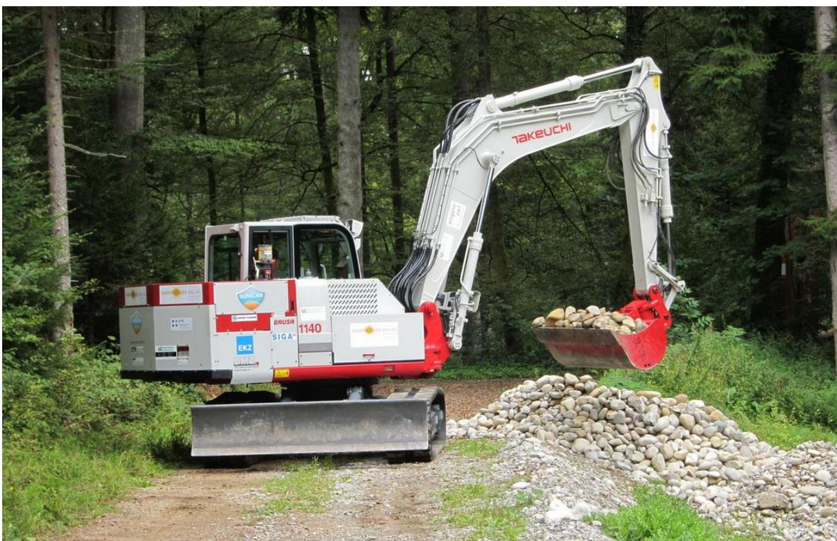
Abbildung 3: 16-t-Demonstrator-Elektrobagger
