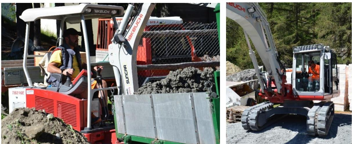
Abbildung 71: 2-t- (links) und 16-t-Elektrobagger (rechts) im Einsatz in Saas-Fee
