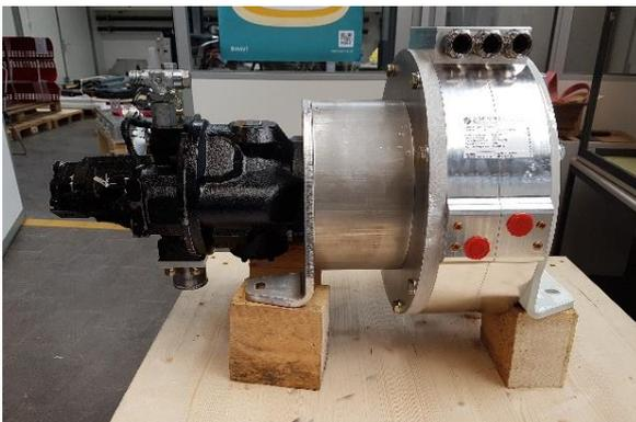
Abbildung 33: Elektrischer Antriebsstrang
