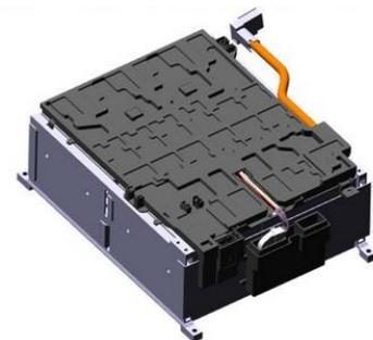
Abbildung 18: Konzept Flüssigkeitskühlung der BMW Batterien
