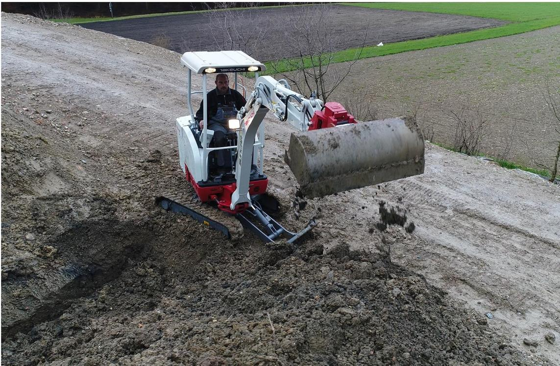
Abbildung 5: 2-t-Elektrobagger
