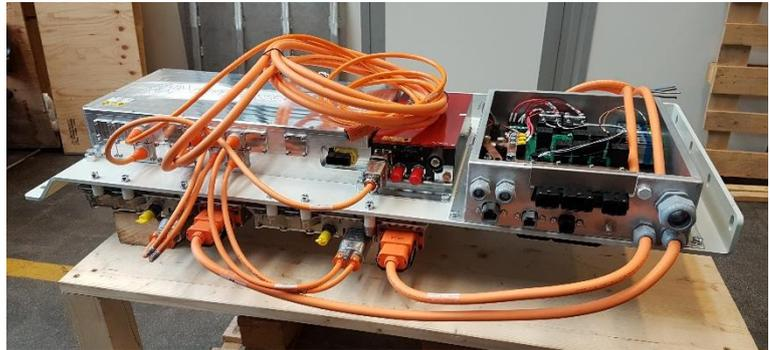
Abbildung 34: Elektroeinheit inklusive Hoch- und Niedervoltverteilung
