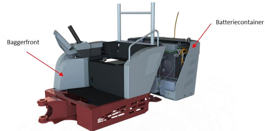
Abbildung 25: CAD Rendering von Baggerfront und Batteriecontainer
