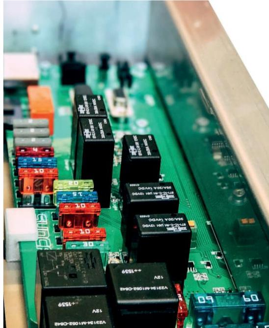
Abbildung 31: Leiterplatte mit Absicherung, Relais und Verteilung der Signale
