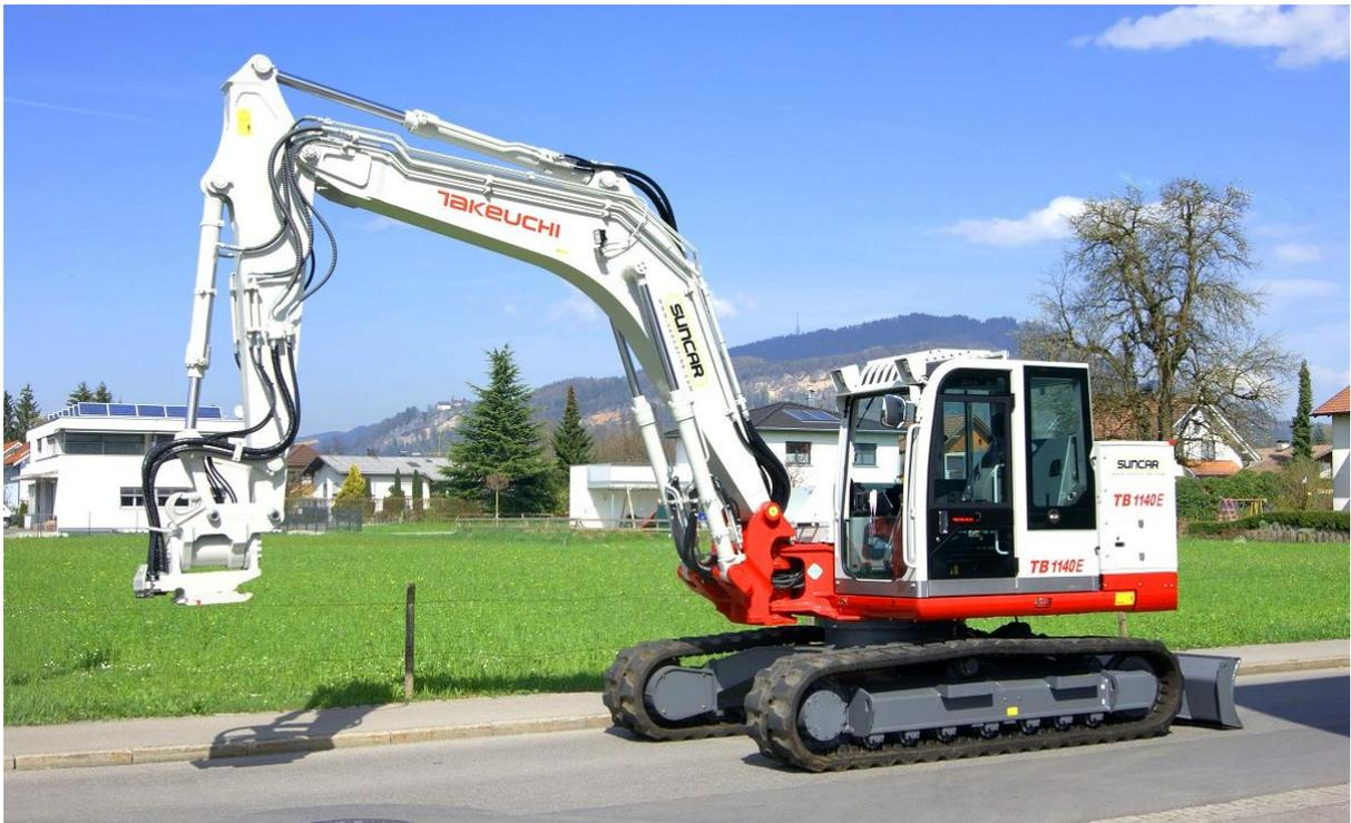
Abbildung 4: 16-t-Elektrobagger, Prototyp 1
