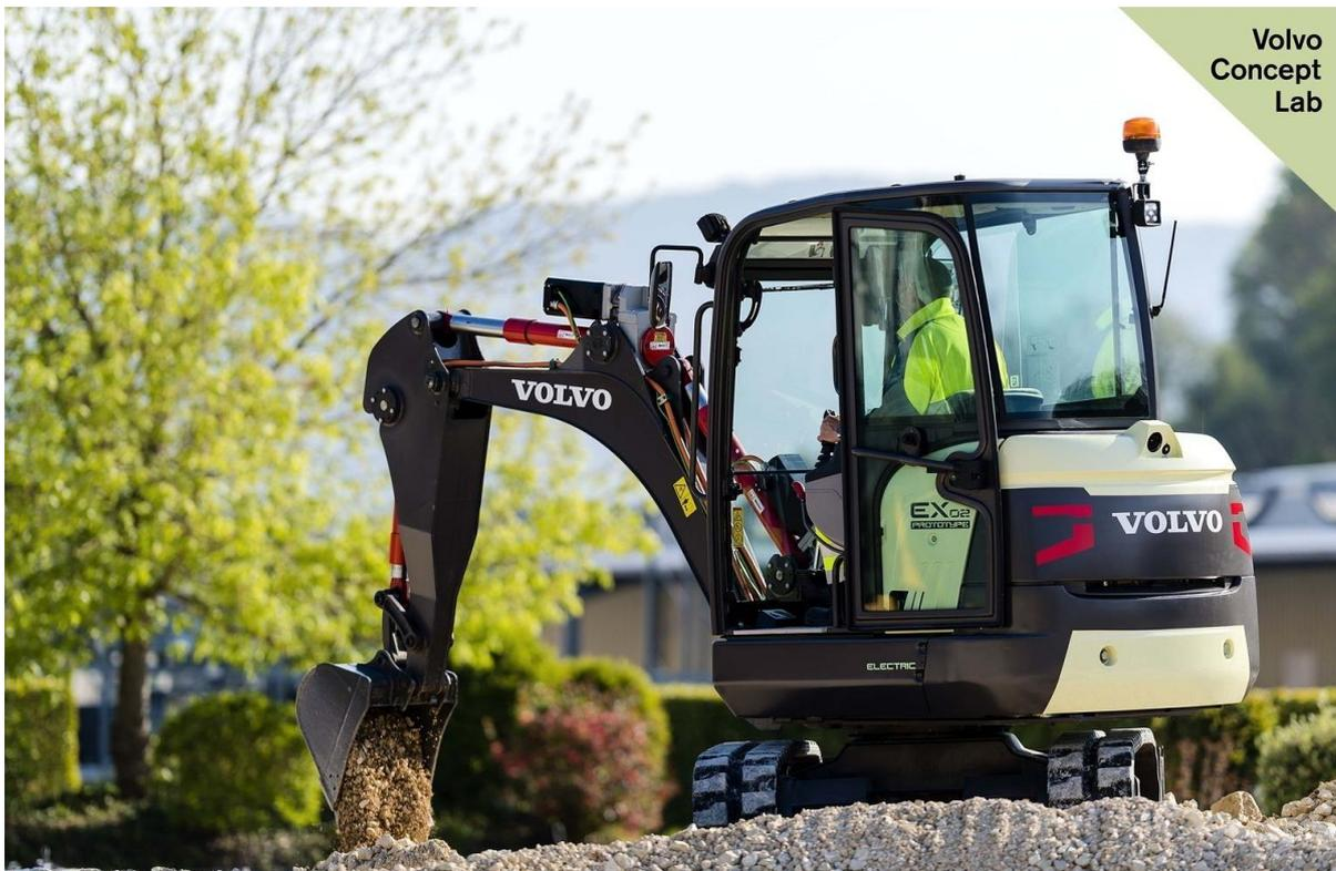
Abbildung 68: Volvo EX2 vollelektrischer Konzeptbagger
