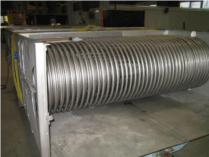
**Abbildung 3 Eine Kassette mit installierten Wärmetauscherrohren während der Fertigung**
