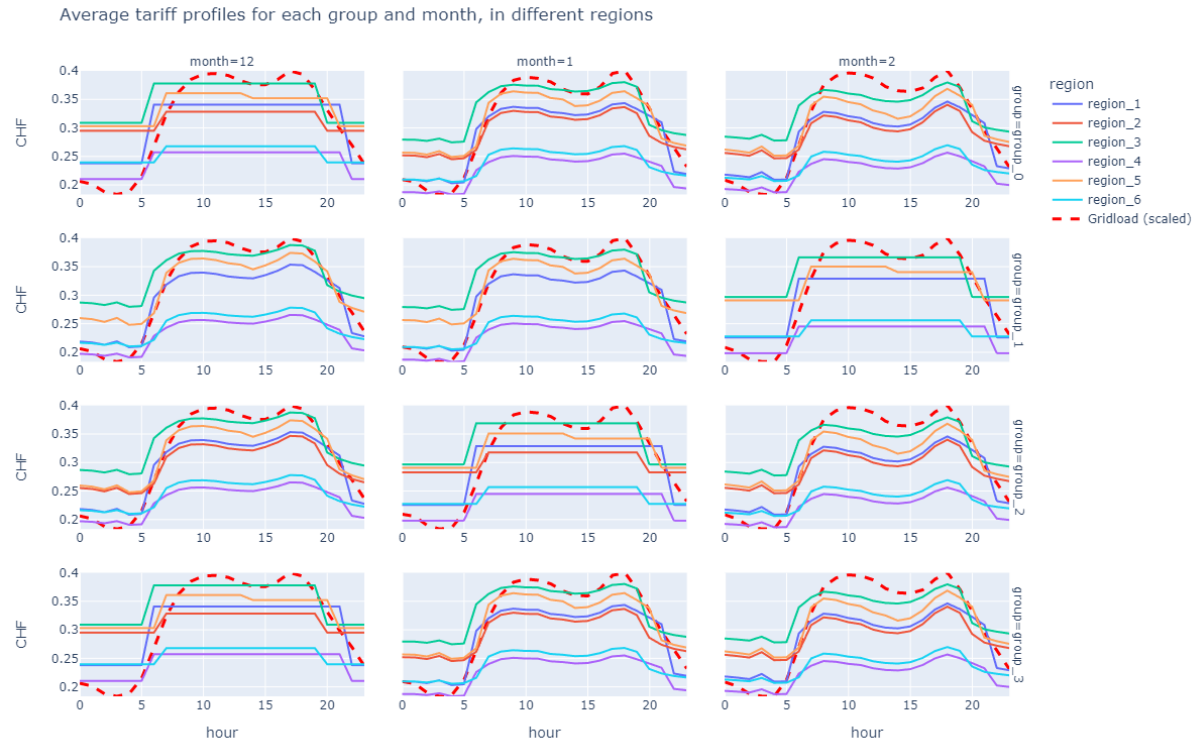
Abbildung 7: Durchschnittliches Tarifprofil der verschiedenen Kundengruppen, Regionen und Monate im Vergleich zur Netzlastprognose (=gestrichelte rote Linie).
